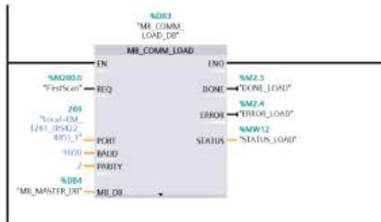
**Figura 79-3:** Configuración de la instrucción “MB\_COMM\_LOAD”.
