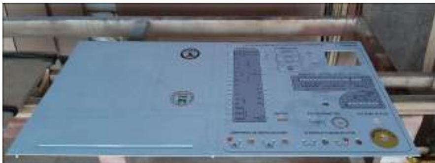
**Figura 63-3:** Implementación de vinil en la plancha de acero.
