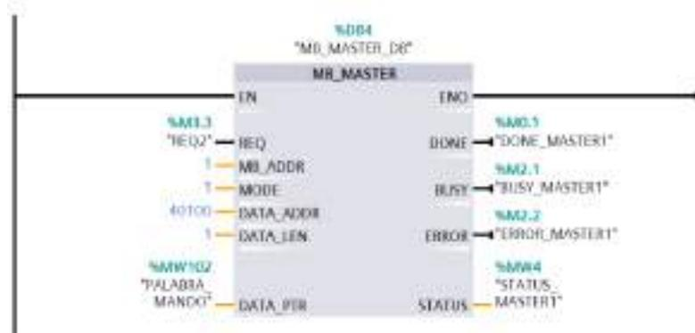
**Figura 80-3:** Configuración de la instrucción “MB\_MASTER” para la escritura de palabras de mando.
