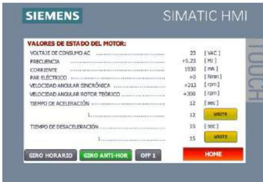
**Figura 108-4:** Monitoreo de motor a través de la HMI KTP400.
