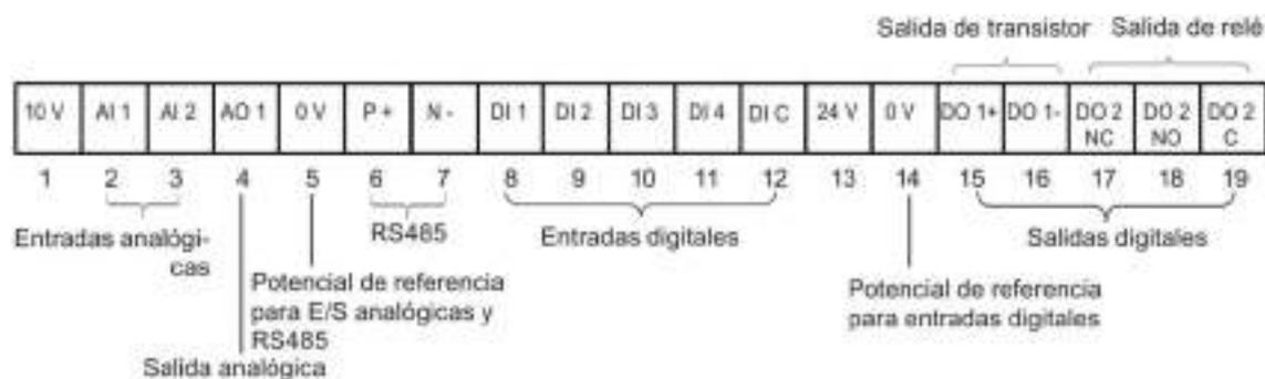
**Figura 40-3:** Bornes de usuario del variador Sinamics V20.
