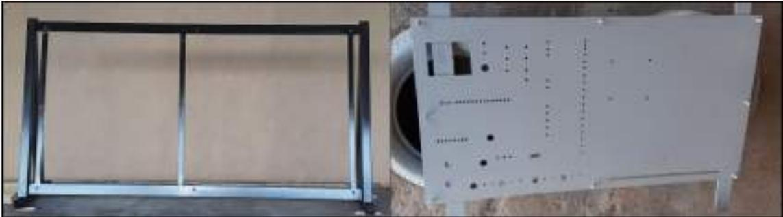
**Figura 62-3:** Acabado mediante pintado del soporte (izquierda) y plancha de acero (derecha).
