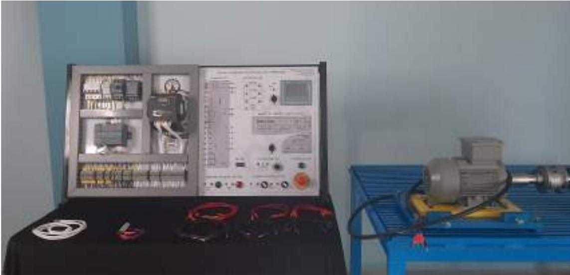
**Figura 66-3:** Sistema de control para un motor trifásico de 1 HP.
