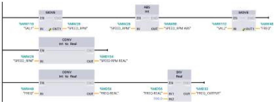
**Figura 87-3:** Programación para tratamiento de datos obtenidos del variador de frecuencia.
