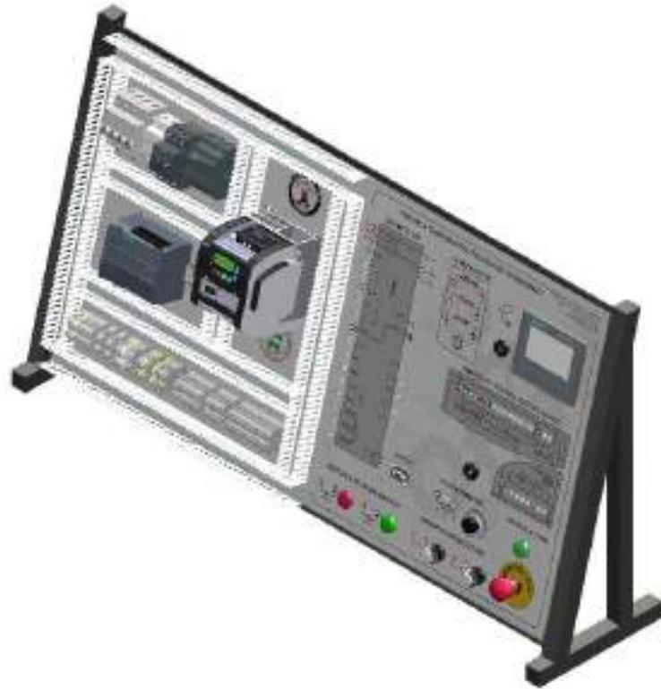
**Figura 57-3:** Modelo 3D del panel de control para un motor trifásico.
