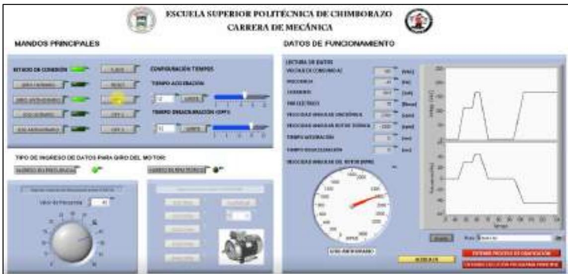
**Figura 110-4:** Control y monitoreo del motor a través de la interfaz LabVIEW.
