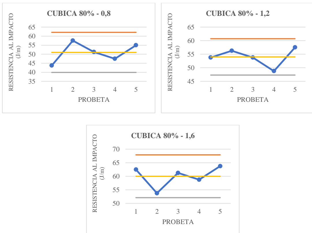
Gráfico 34-4: Gráficos de control de la energía de impacto en las probetas de PLA, mallado Cúbica al 80% relleno y 0.8; 1.2 y 1.6 mm de espesor de pared.
