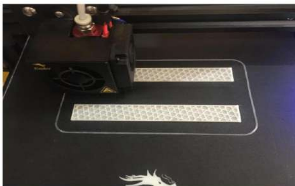
Figura 8-3: Impresión probeta ABS y PLA
