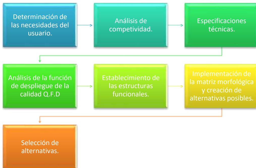
**Figura 1-3:** Metodología de diseño del respirador.
