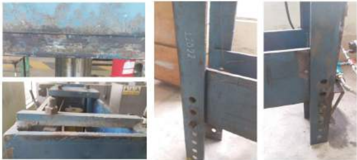
Figura 47-3. Zona exterior afectadas por la corrosión generalizada.
