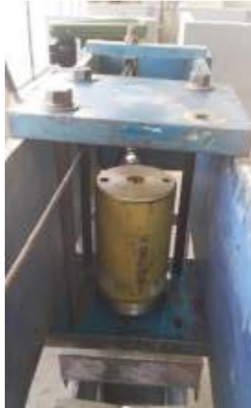
Figura 22-3. Montaje del cilindro hidráulico y sus soportes.
