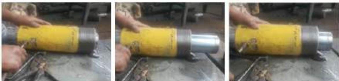
Figura 34-3. Montaje y funcionamiento del cilindro hidráulico
