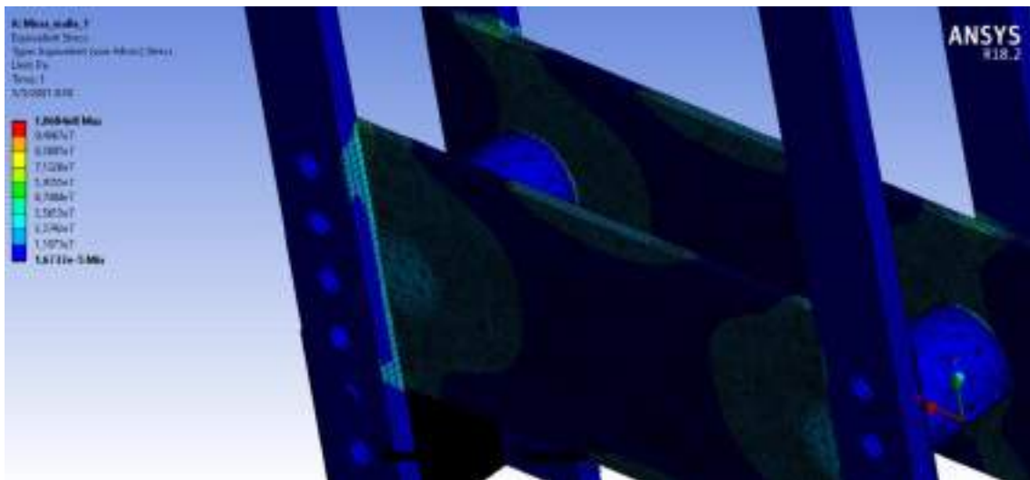
Figura 115-3. Esfuerzo máximo obtenido mediante el software ANSYS, utilizando una malla Jacobian Ratio
