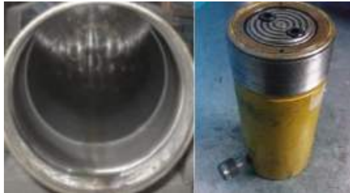
Figura 31-3. Bruñido del cilindro hidráulico
