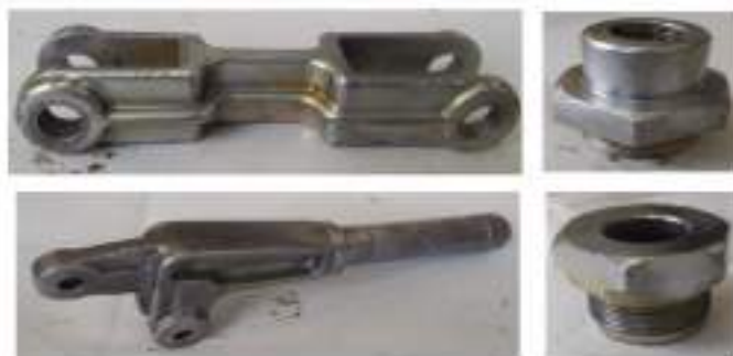
Figura 52-3. Preparación de las piezas de la bomba con SSPC-SP3.
