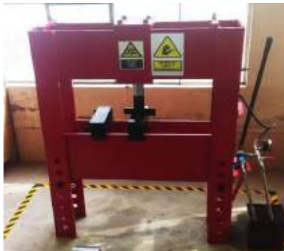
Figura 140-4. Presentación de la prensa realizado el mantenimiento correctivo.
