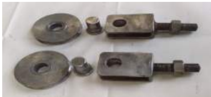
Figura 51-3. Preparación de las poleas con SSPC-SP3.
