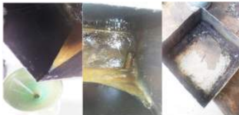
Figura 42-3. Daños en el tanque de aceite.
