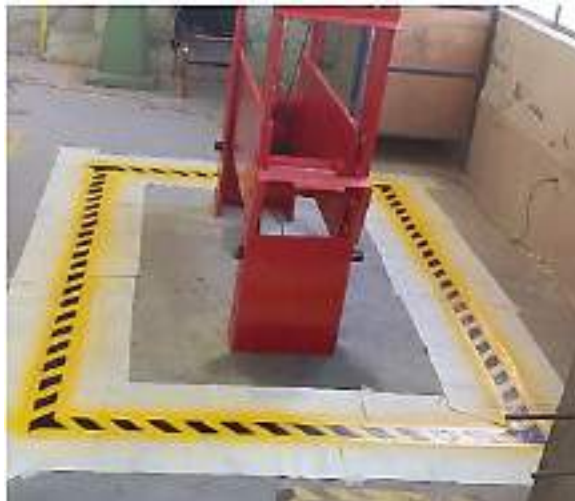
Figura 67-3. Línea de seguridad para lugares de peligro y obstáculos
