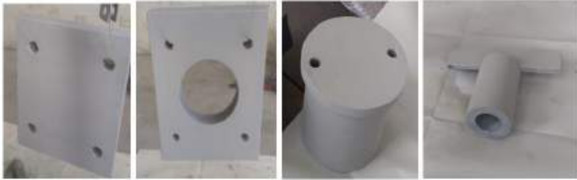
Figura 57-3. Soportes del cilindro hidráulico con recubrimiento primario.
