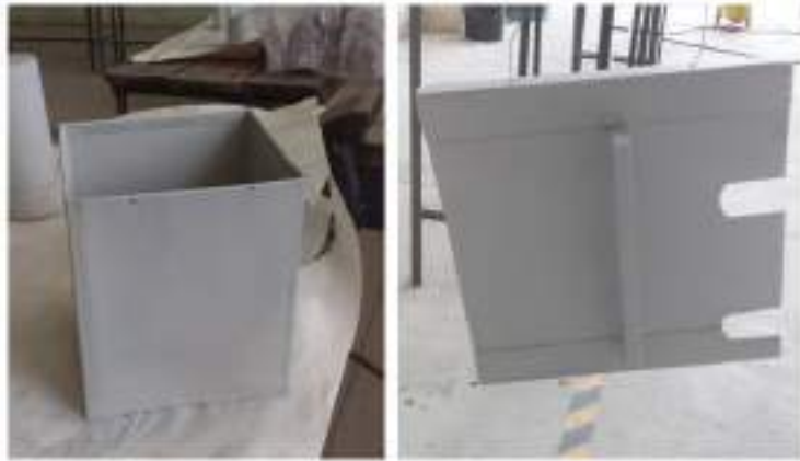
Figura 60-3. Reservorio de aceite con recubrimiento primario.
