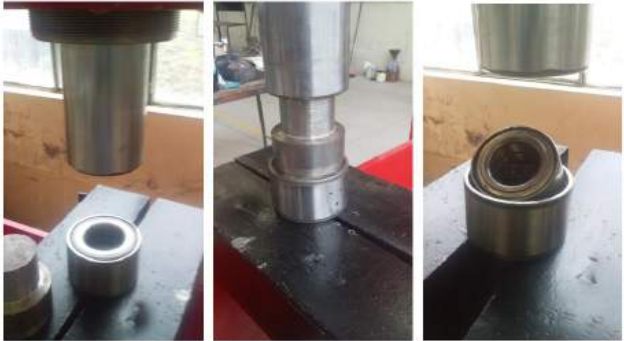
Figura 149-4. Desmontaje de un rodamiento de diámetro interior 38 mm.
