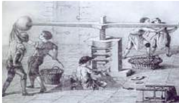
Figura 1-2. Prensa de balancín de Nicolas Briot (1626).
