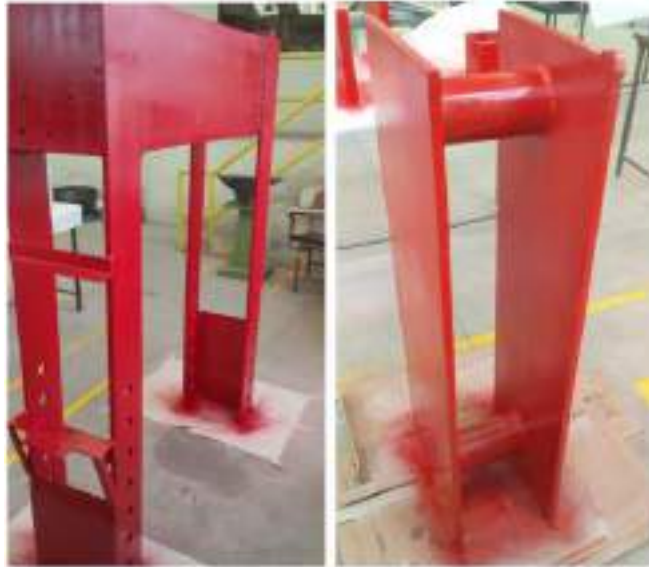
Figura 66-3. Estructura metálica con recubrimiento de acabado.
