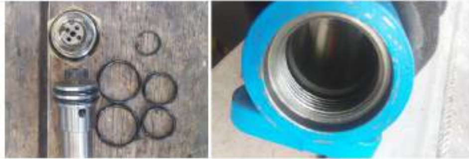
Figura 38-3. Reparaciones de la bomba hidráulica manual.
