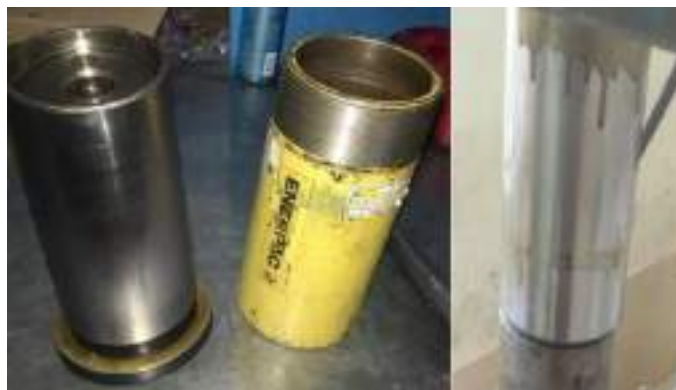
Figura 30-3. Fallas del cilindro hidráulico.
