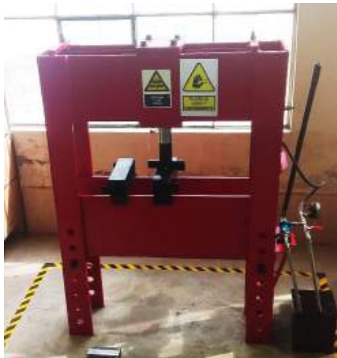
Figura 69-3. Prensa hidráulica realizado el mantenimiento correctivo.
