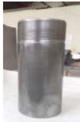
Figura 54-3. Preparación del cilindro hidráulico con SSPC-SP3
