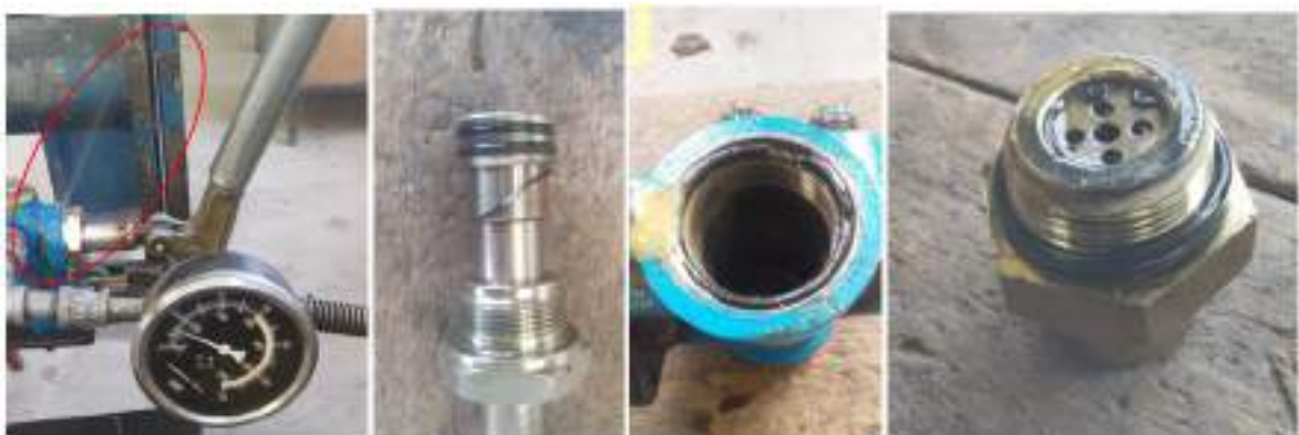
Figura 37-3. Fallas de la bomba hidráulica
