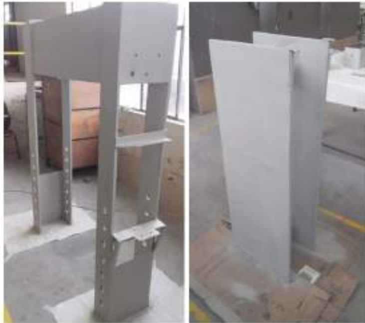
Figura 61-3. Estructura metálica con recubrimiento primario.
