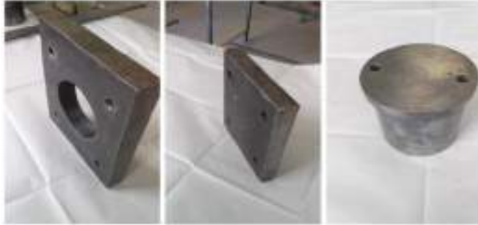
Figura 53-3. Preparación de los soportes del cilindro hidráulico con SSPC-SP3.
