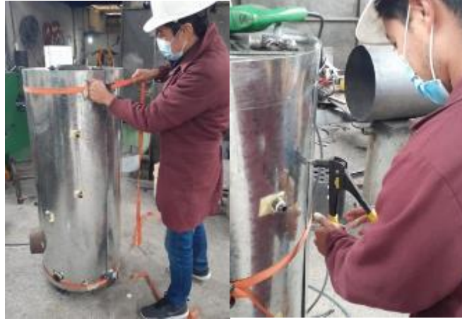
Figura 58-3: Forrado con tol galvanizado.
