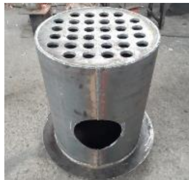
Figura 46-3: Ensamble del espejo con el doble fondo.
