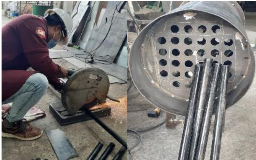
Figura 50-3: Corte de los tubos de humo.
