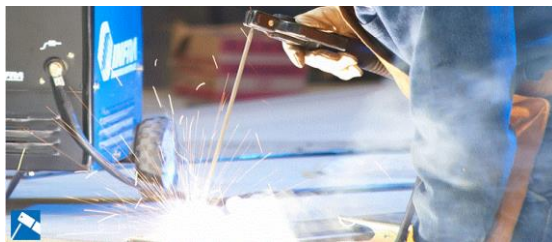
Figura 17-2: Proceso de soldadura SMAW
