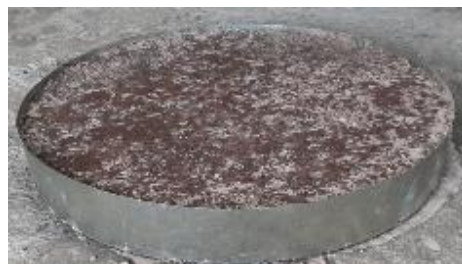
Figura 55-3: Base de cemento refractario.
