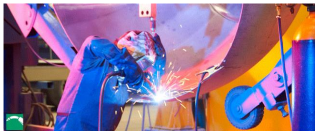
Figura 15-2: Proceso de soldadura MIG
