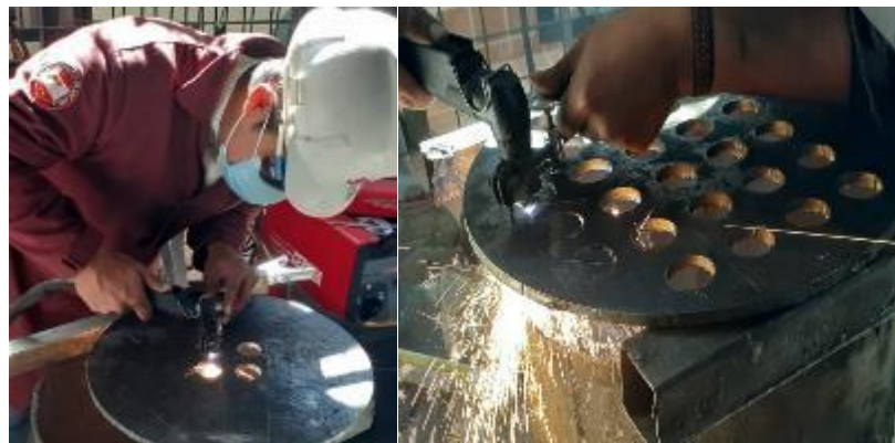
Figura 42-3: Corte con plasma de los agujeros para los tubos de humo.
