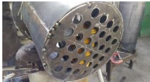
Figura 45-3: Punteado del espejo con el doble fondo.
