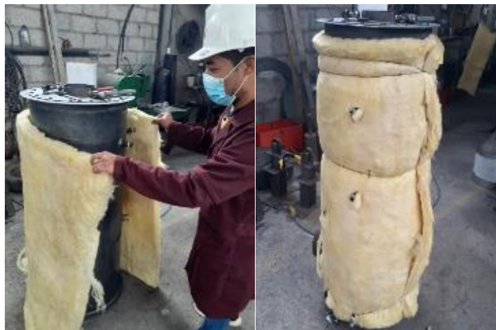
Figura 57-3: Colocación de la fibra de vidrio.
