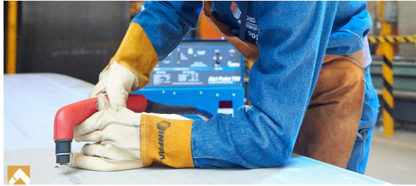
Figura 18-2: Proceso de soldadura PAC
