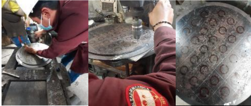
Figura 41-3: Guía para el corte con plasma de los agujeros.
