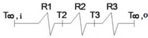
Figura 14-3: Circuito térmico de la tubería de cobre.
