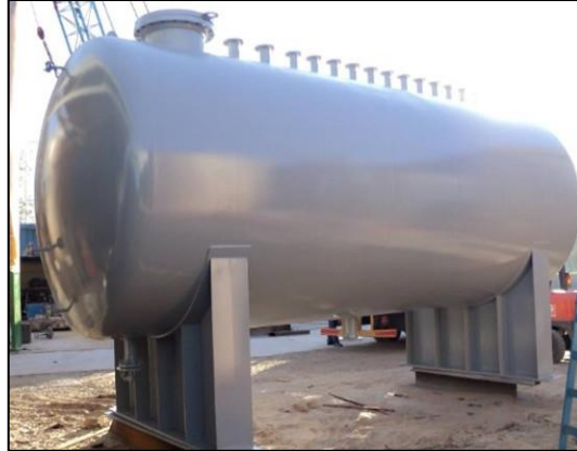
Figura 4 – 2. Tanque a baja presión
