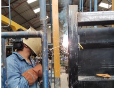
Figura 49-3: Soldado de las placas base al porta probetas. Realizado por: Taday J., Panchi A., 2021.
