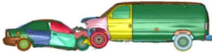
Figura 23-2: Simulación de un impacto frontal.
