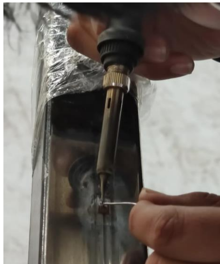
Figura 60-3: Posición correcta del cautín. Realizado por: Taday J., Panchi A., 2021.
