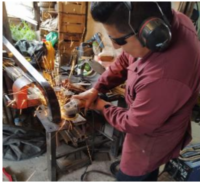
Figura 47-3: Pulido de la superficie soldada. Realizado por: Taday J., Panchi A., 2021.
