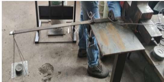
Figura 39-3: Prototipo final para obtener lecturas de deformación. Realizado por: Taday J., Panchi A., 2021.
