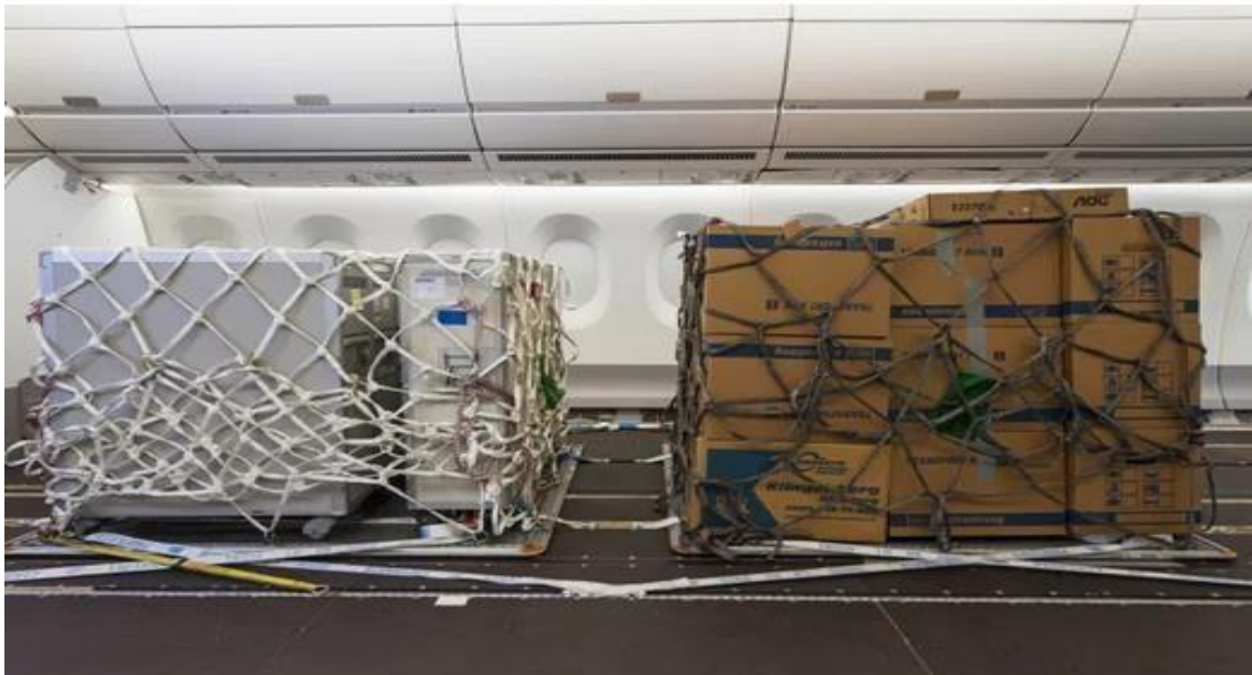
Figura 4-3. Adaptación de un Airbus A330 de pasajeros a carga
