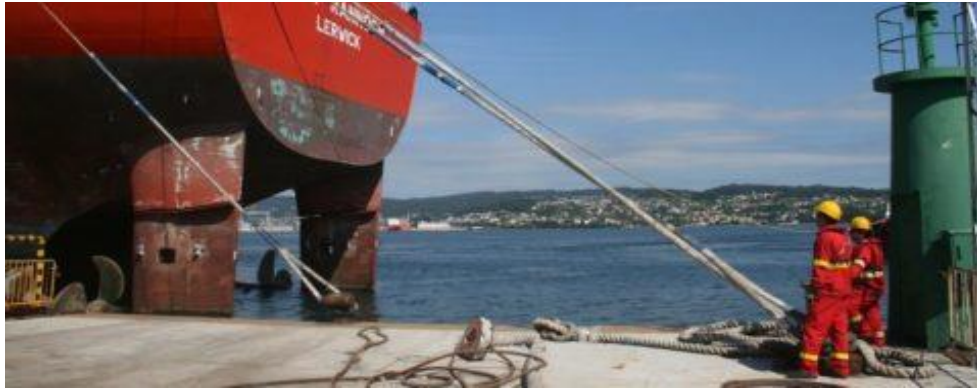
Figura 2-1: Operaciones de amarre y desamarre de buques.
