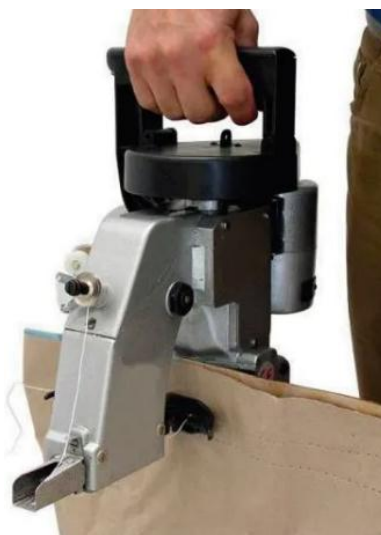
Figura 8 – 3: Máquina cosedora de sacos
