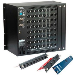
Figura 9-3: D rack 48in/16out Realizado por: Mejía G. Omar, 2021
