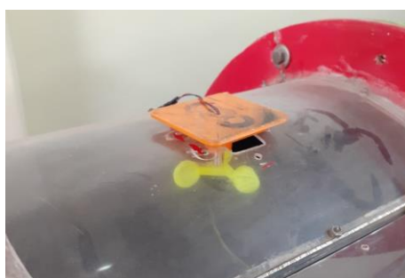
Figura 42-3: Montaje del anemómetro
