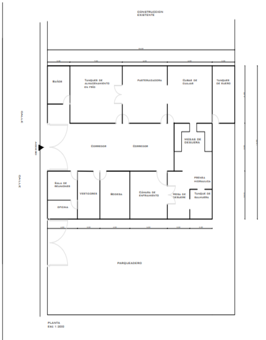
Figura 4-3: Distribución de la planta
