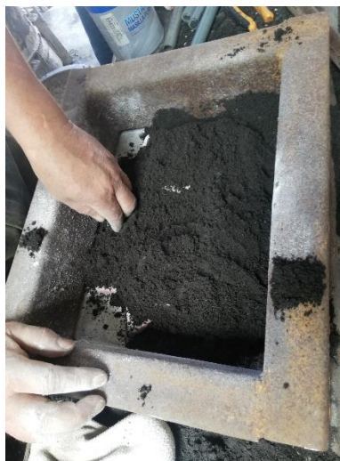
Figura 54-3: Rumos de arena para cubrir los modelos
