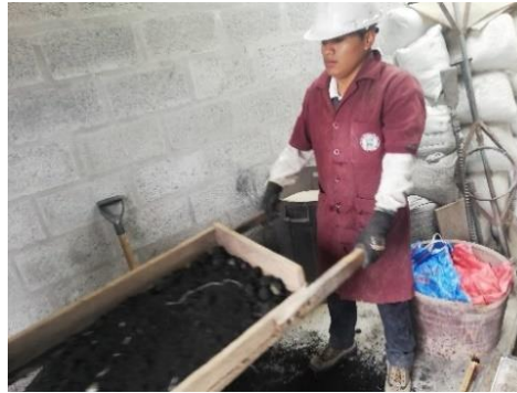
Figura 51-3: Tamizado artesanal de la arena
