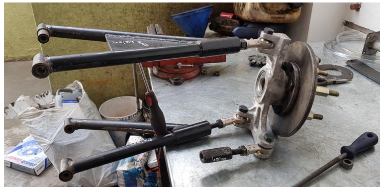
Figura 64-3: Armado mangueta delantera
