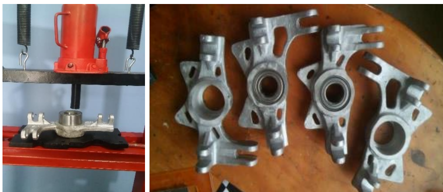
Figura 63-1: Prensado del rodamiento en las manguetas
