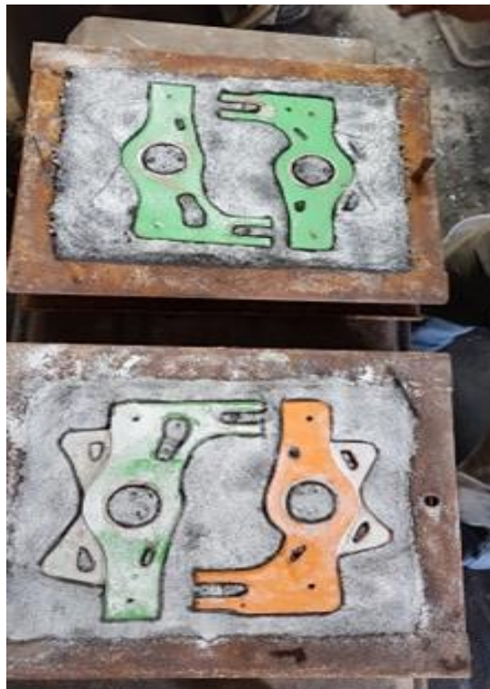
Figura 56-3: Machos finales para extraer modelos
