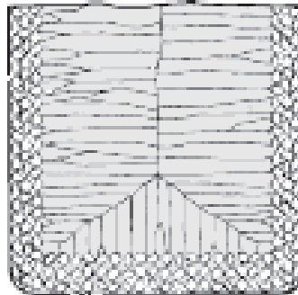
Figura 17-2: Crecimiento de granos metálicos
