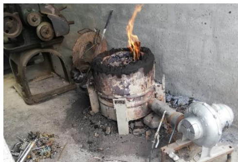
Figura 74-3: Encendido del quemador.
