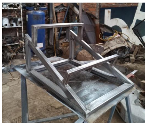
Figura 118-3: Soldadura de perfiles.
