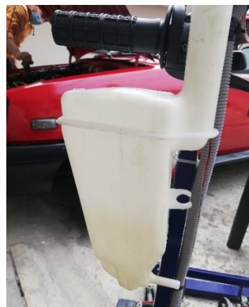
Figura 114-3: Vaciado de tanque de combustible.
