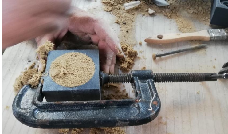
Figura 62-3: Prensado de caja de machos.
