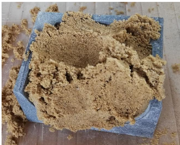
Figura 61-3: Compactación de la arena de sílice.
