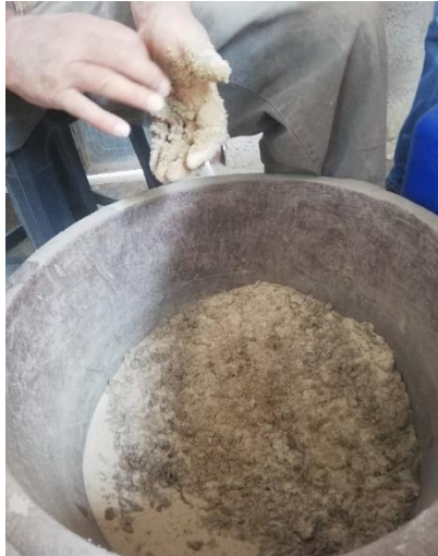
Figura 49-3: Mezcla uniforme de arena con resina
