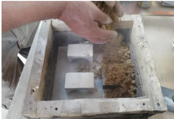
Figura 52-3: Elaboración de caja para moldes de matriz de bronce.
