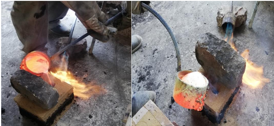
Figura 78-3: Vertido de bronce fundido.
