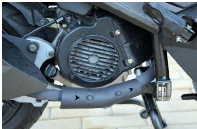
Figura 9-2: Refrigeración por Aire forzado
