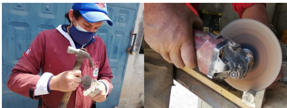
Figura 81-3: Eliminación de exceso de material.
