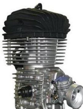
Figura 8-2: Refrigeración por Aire
