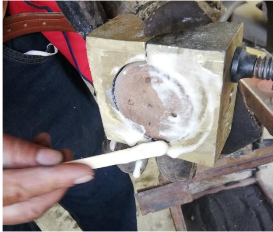
Figura 88-3: Eliminación de aberturas.
