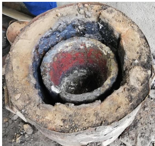
Figura 67-3: Crisol con horno de fundición.
