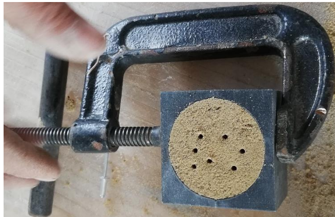
Figura 63-3: Creación de orificios para molde de macho.
