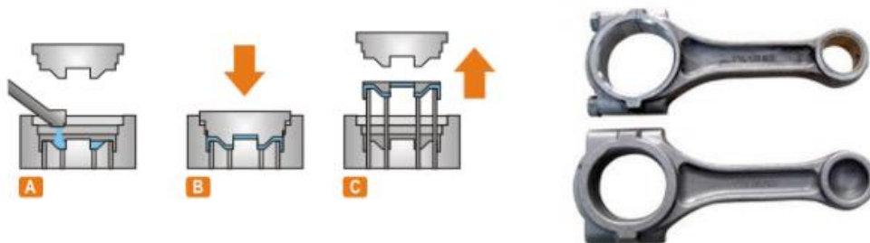
Figura 16-2: Descripción esquemática de proceso del moldeado por compresión
