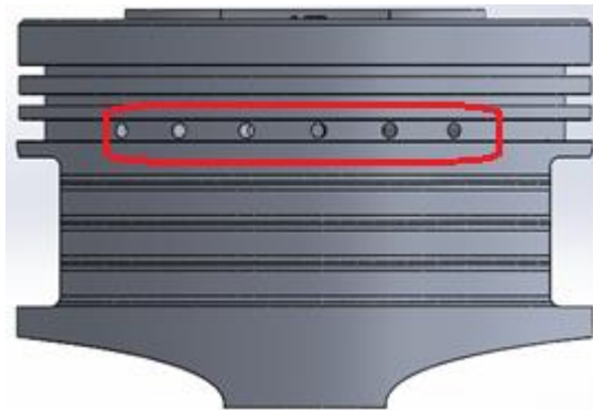
Figura 6-3: Orificios de lubricación parte media
