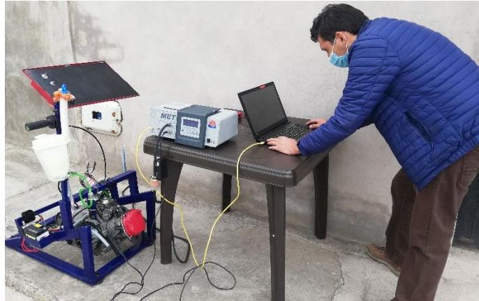
Figura 134-3: Medición de gases
