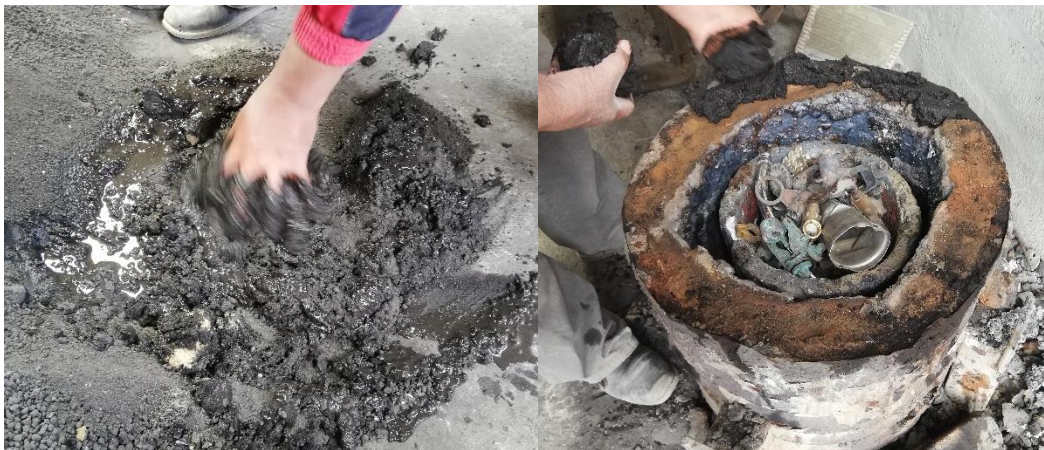
Figura 71-3: Aplicación de arena de sílice con agua al horno.
