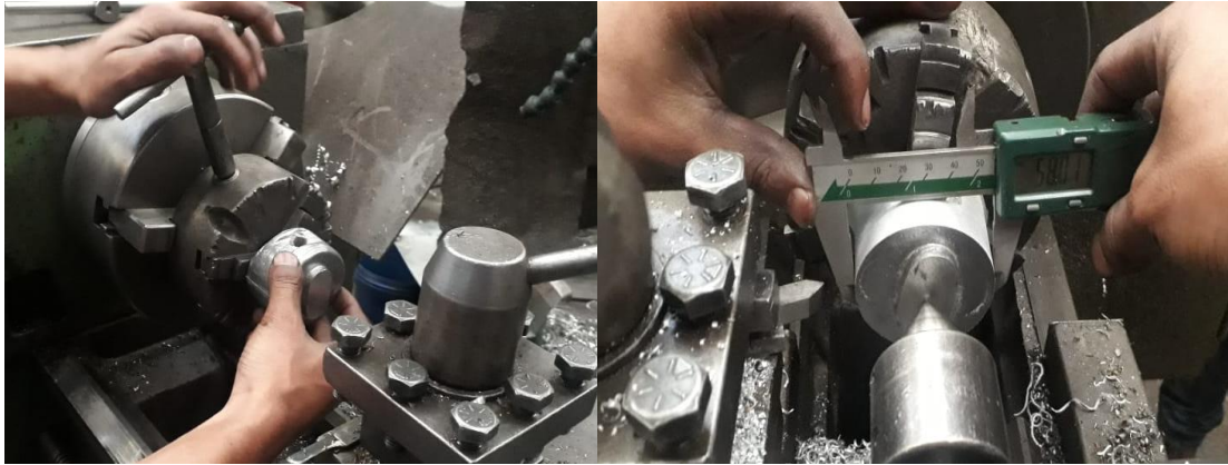
Figura 96-3: Proceso de cilindrado.
