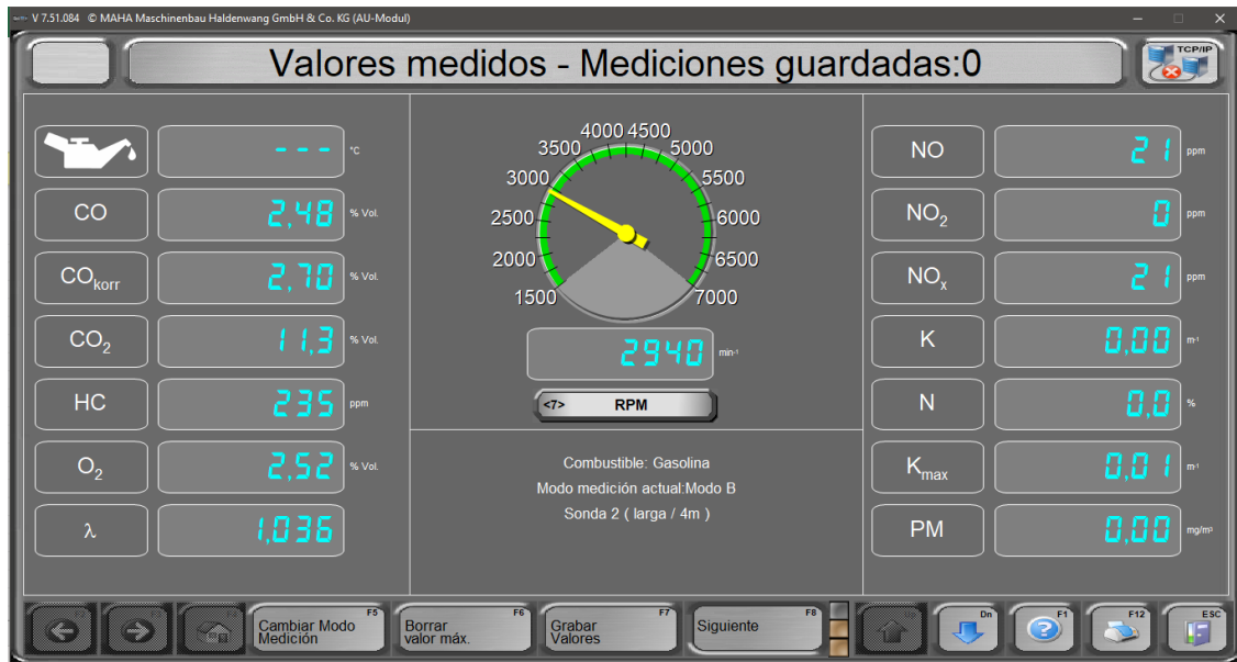
Gráfico 5-3: Medición de gases con pistón modificado, motor caliente.
