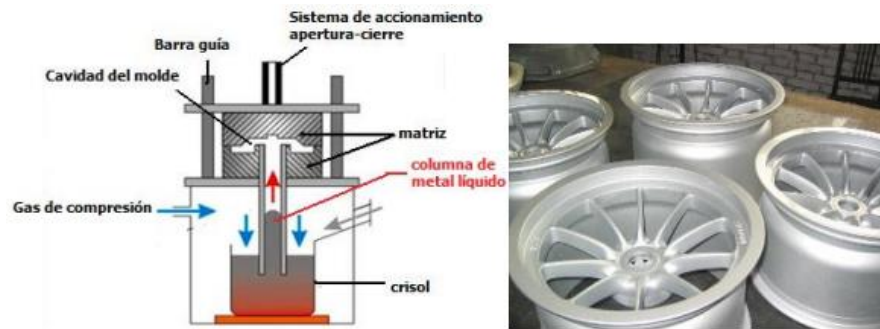
Figura 17-2: Fundición a baja presión y ejemplo de aplicación del proceso. Fuente: Ortiz et al., 2013
