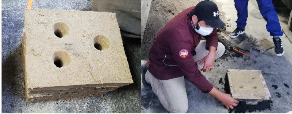
Figura 77-3: Aplicación de arena de sílice con agua al molde.
