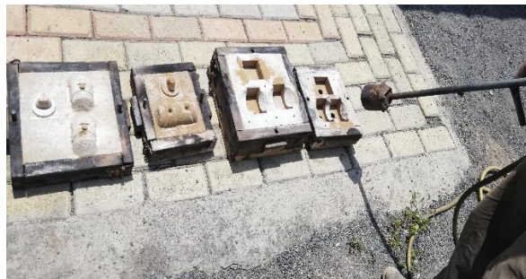
Figura 76-3: Eliminación de humedad.
