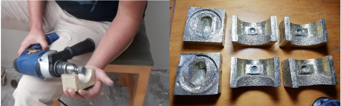
Figura 82-3: Eliminación de porosidad de bronce.
