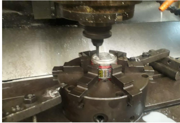
Figura 102-3: Eliminación de material de cabeza de pistón.
