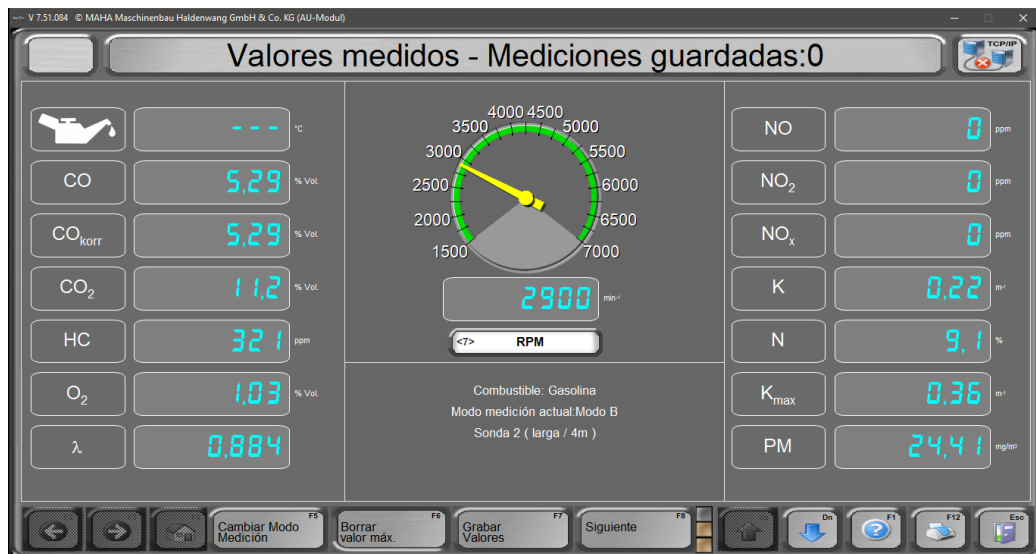
Gráfico 2-3: Medición de gases con pistón estándar, motor frío.
