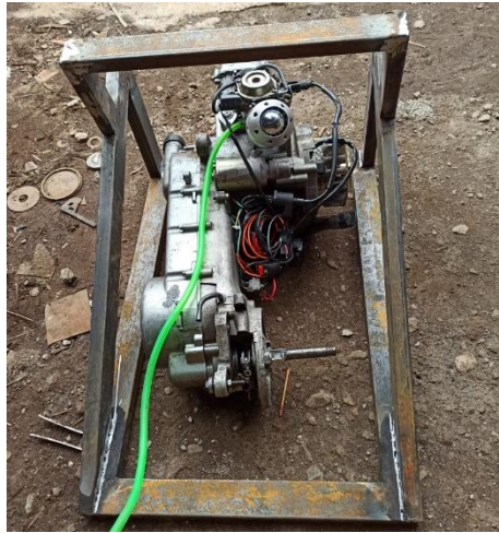
Figura 119-3: Acoplamiento entre motor y base.
