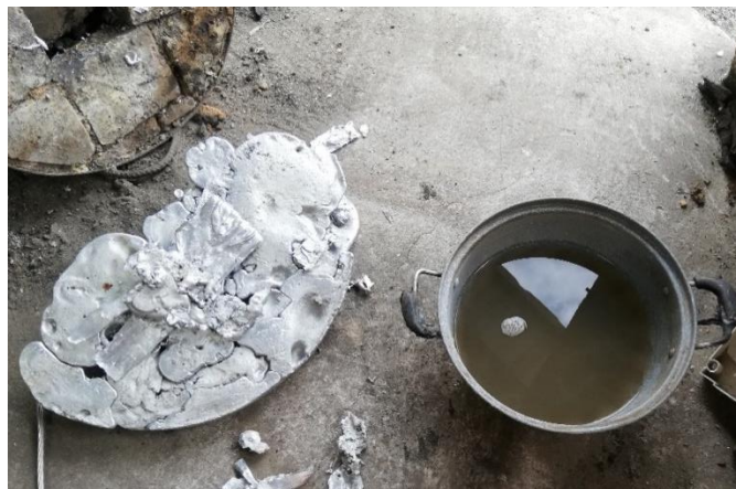
Figura 83-3: Eliminación de impurezas del aluminio.
