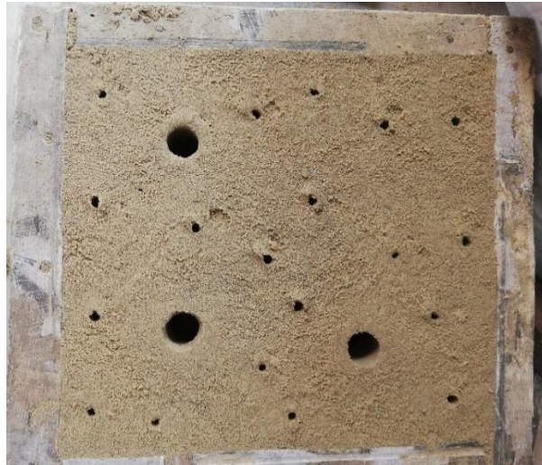
Figura 54-3: Creación de orificios para verter bronce de fundición.
