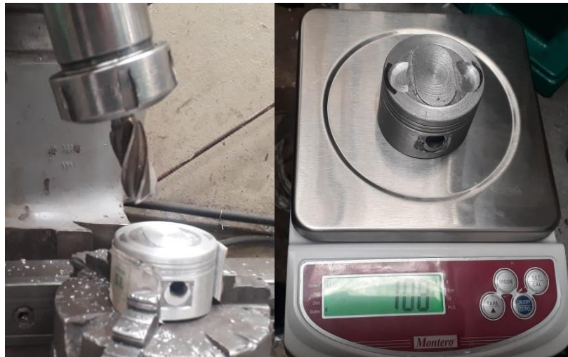
Figura 99-3: Espacio para válvulas.
