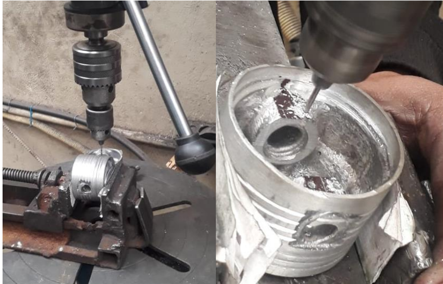
Figura 98-3: Agujeros de lubricación.
