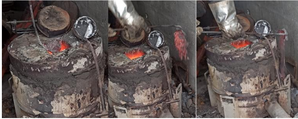
Figura 111-3: Eliminación de impurezas de la colada.
