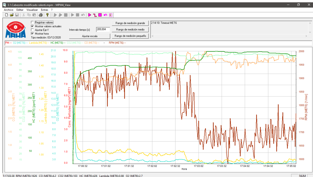
Figura 151-3: Medición de emisión de gases a 1700 rpm en cabezote modificado.
