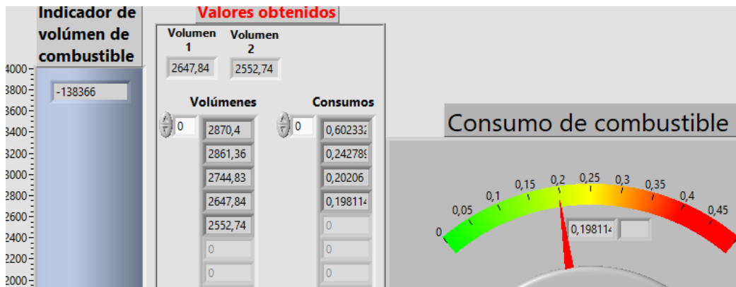
Figura 138-3: Consumo de combustible a 5000 RPM en cabezote original.
