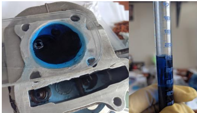
Figura 5-3: Medición de volúmenes con bureta graduada.
