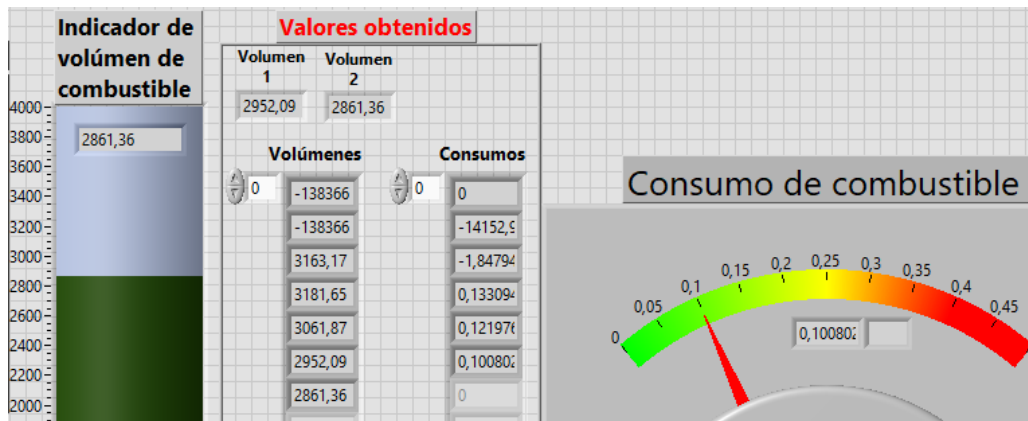
Figura 140-3: Consumo de combustible a 3700 RPM en cabezote modificado.
