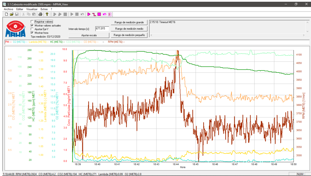
Figura 153-3: Medición de emisión de gases a 3700 rpm en cabezote modificado.
