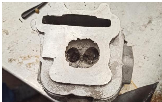
Figura 121-3: Planeado de cara superior e inferior.
