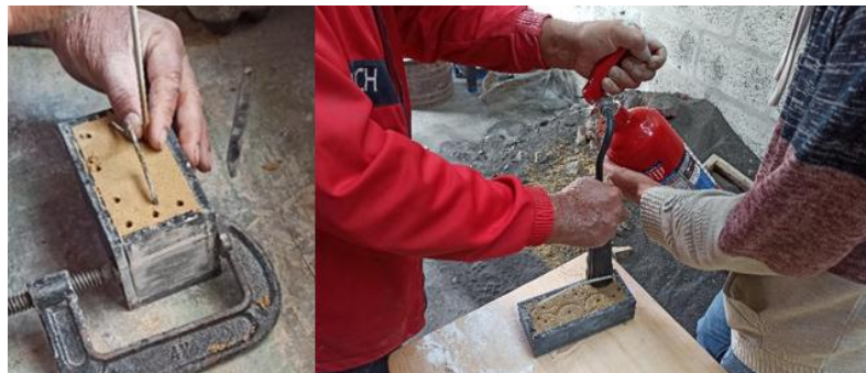
Figura 98-3: Inyección de CO 2 .
