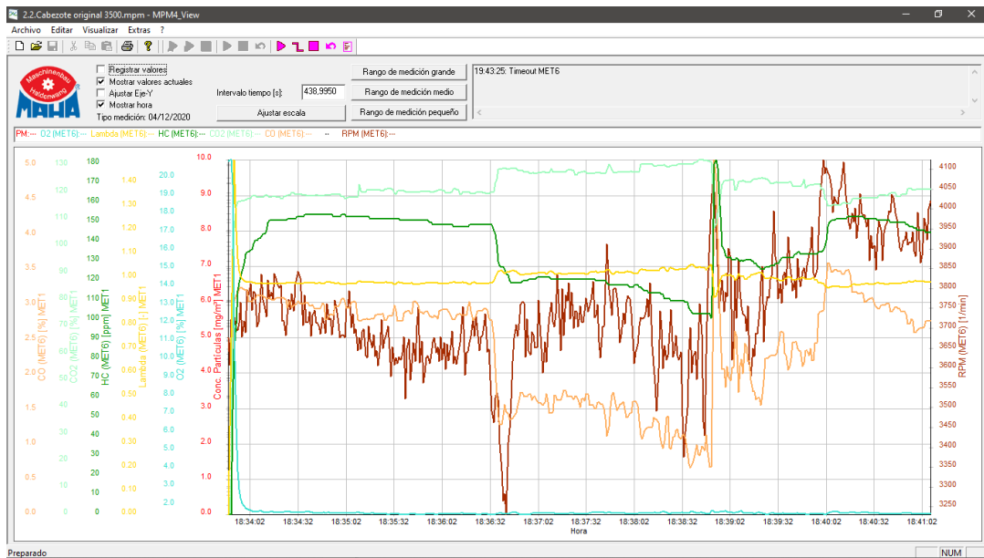
Figura 145-3: Medición de emisión de gases a 3700 rpm en cabezote original.
