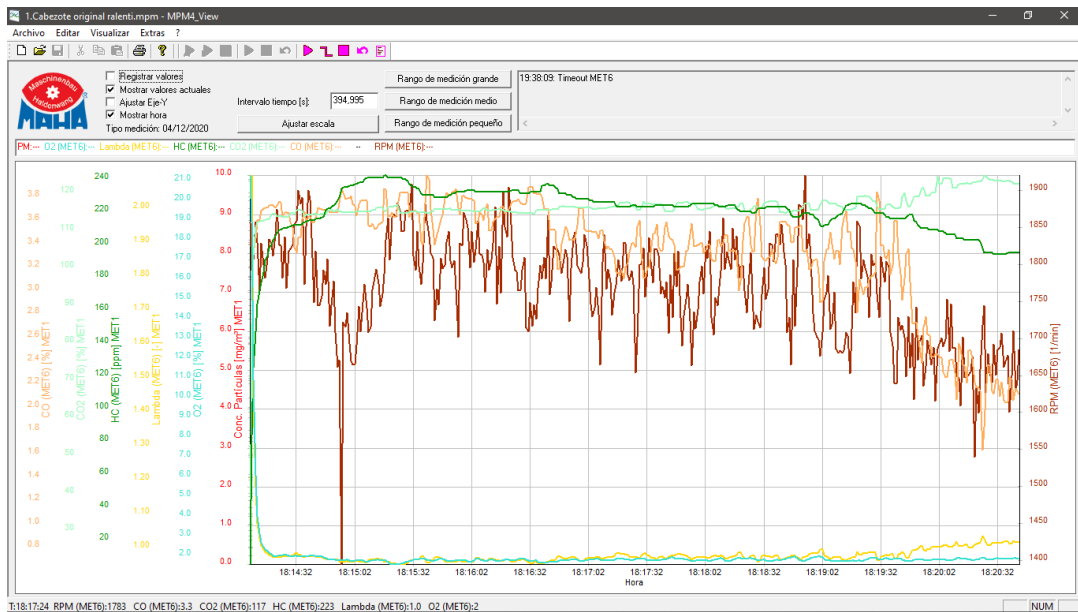
Figura 143-3: Medición de emisión de gases a 1700 rpm en cabezote original.
