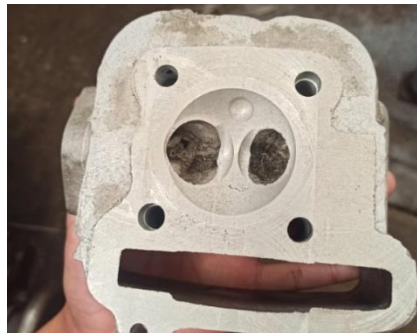
Figura 125-3: Desbaste de cámara.
