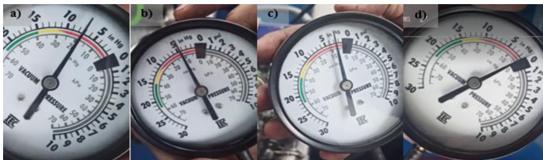
Figura 7-3: Medición de vacío. a) 1700 rpm. b) 3700 rpm. c) 5000 rpm. d) 7000 rpm.
