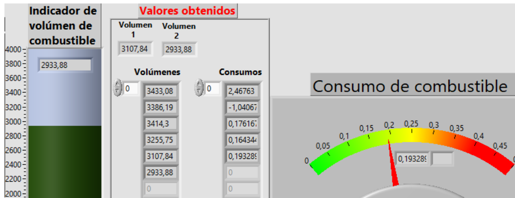
Figura 137-3: Consumo de combustible a 3700 RPM en cabezote original.
