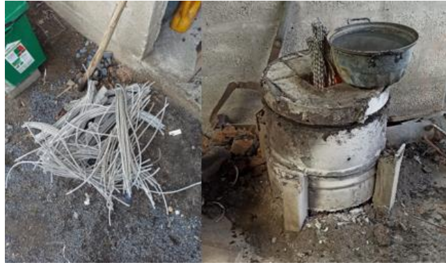
Figura 109-3: Colocación de aluminio en el interior del horno.
