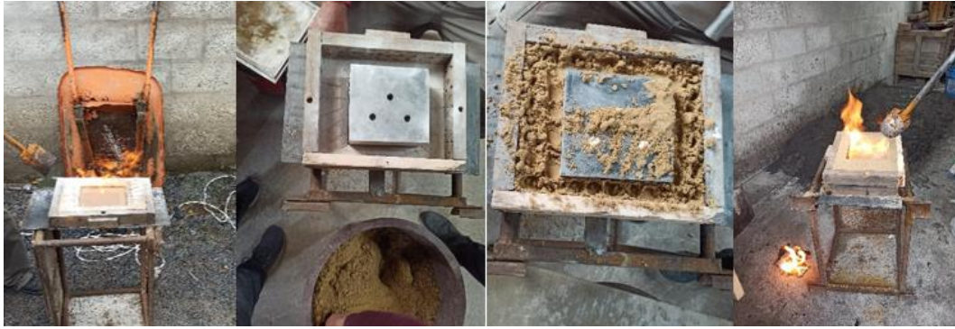
Figura 103-3: Elaboración del molde maestro.
