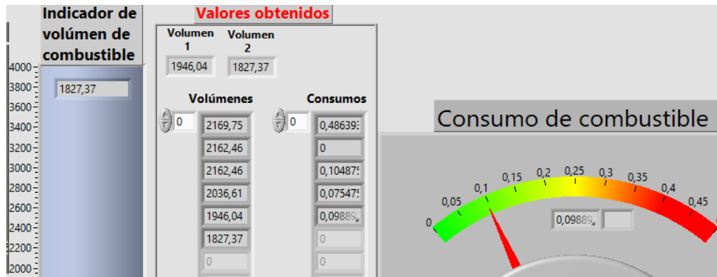
Figura 136-3: Consumo de combustible a 1700 RPM en cabezote original.
