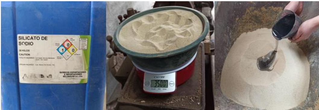
Figura 94-3: Mezcla de arena y silicato de sodio para la elaboración de galletas.
