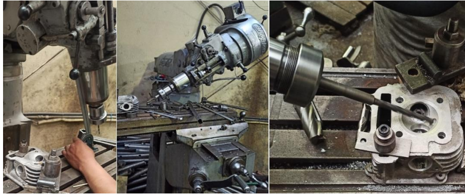
Figura 128-3: Ajuste de cabezal y mecanizado de perforación para bujía.
