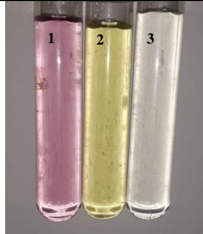
Fotografía 10: Tubo 1: Prueba colorimétrica de captadores pasivos Tubo 2: Solución para análisis de biomonitores Tubo 3: Solución blanco.
