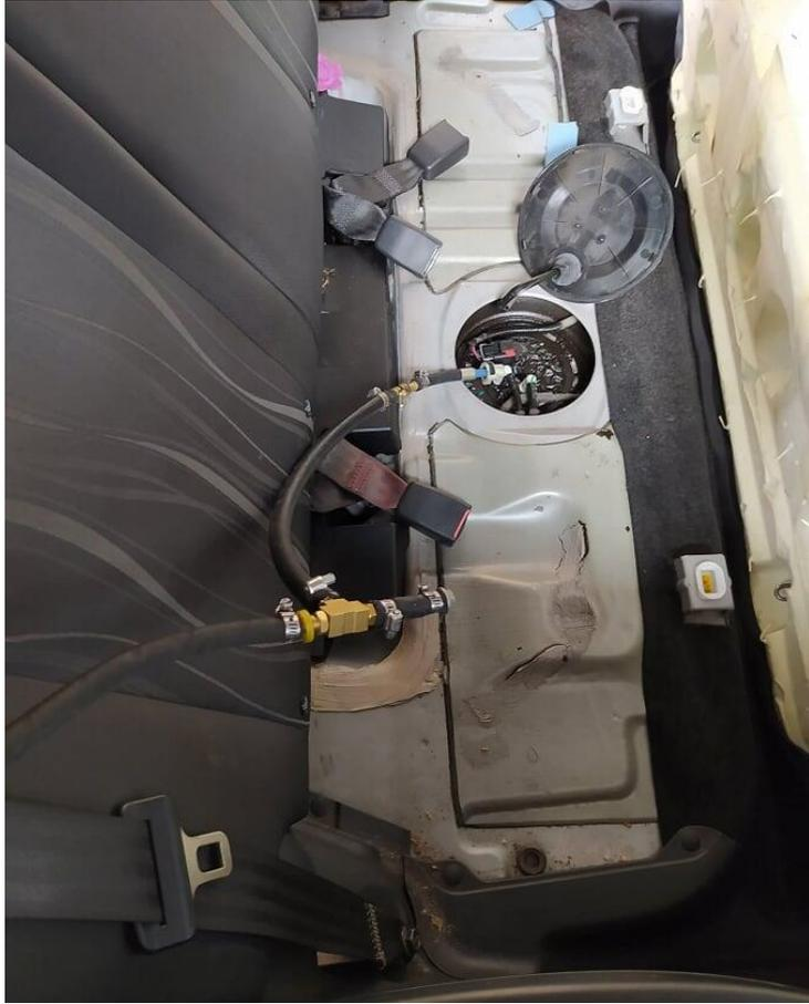
**Figura 3-3:** Conexión de bomba de presión externa.
