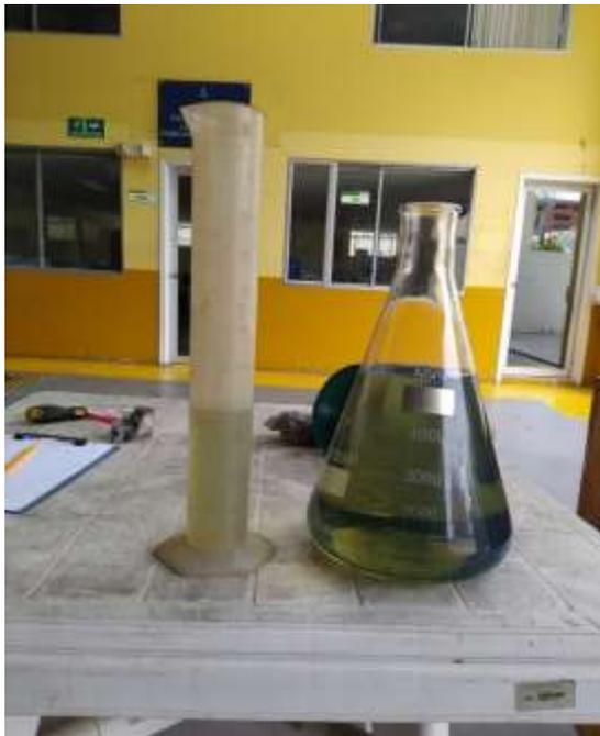
**Figura 14:** Matraz y probeta, para cálculo de consumo de combustible y medición de concentraciones aplicadas en la bomba externa.
