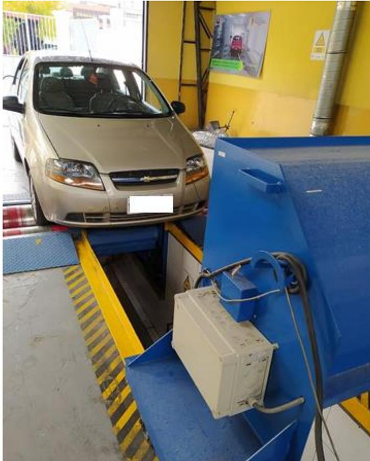
**Figura 7-3:** Vehículo preparado para las pruebas de consumo bajo el ciclo IM-240
