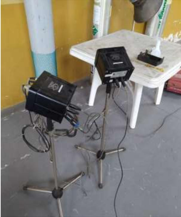
**Figura 9:** Equipos para transmisión de datos al software del dinamómetro.
