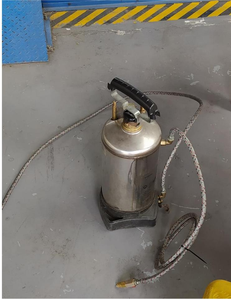
**Figura 2-3:** Bomba de presión externa.
