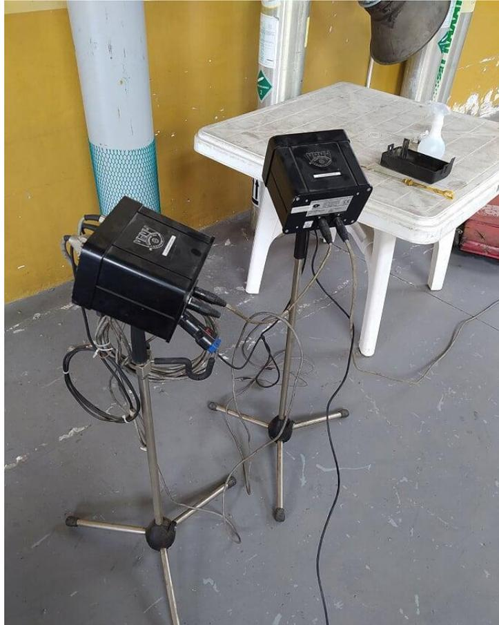
**Figura 6-3:** Equipos de conexión entre vehículo y dinamómetro de chasis.
