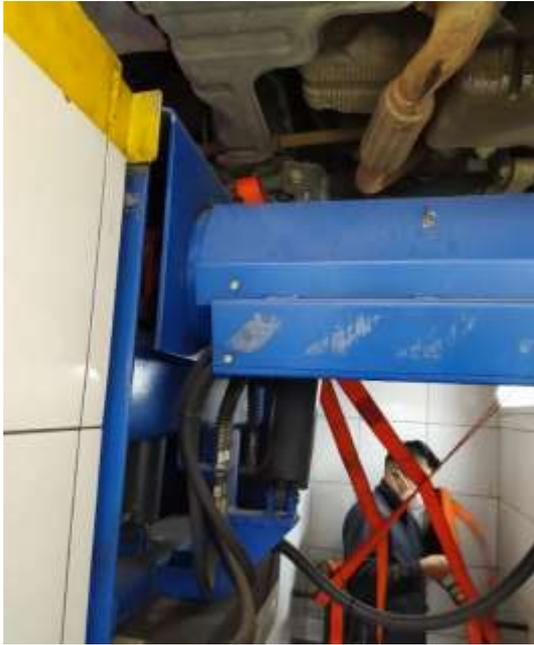
**Figura 7:** Sujeción del vehículo a los puntos de anclaje de la estructura del dinamómetro.
