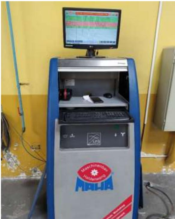
**Figura 8:** Alojamiento del computador y software del dinamómetro LPS 3000.
