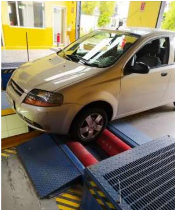
**Figura 6:** Aveo Family 1500cc, vehículo para realizar las pruebas acoplado en el dinamómetro.
