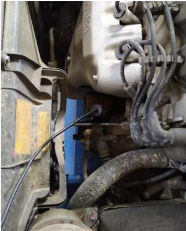
**Figura 10:** Conexión del sensor de temperatura de aceite para envío de datos de la temperatura del motor al software del dinamómetro.
