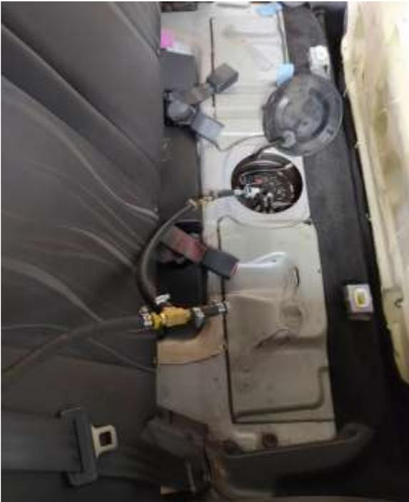
**Figura 12:** Conexión de bomba externa.
