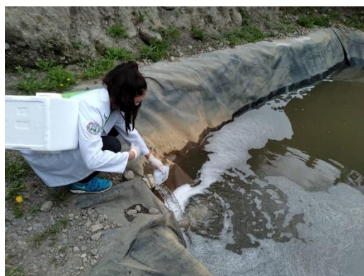
Figura 2-2. Recolección de muestras de agua tomadas directamente del tanque.
