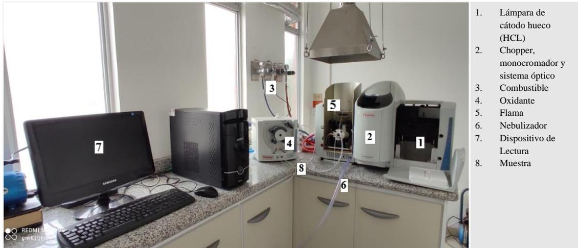
1. Lámpara de cátodo hueco (HCL)
