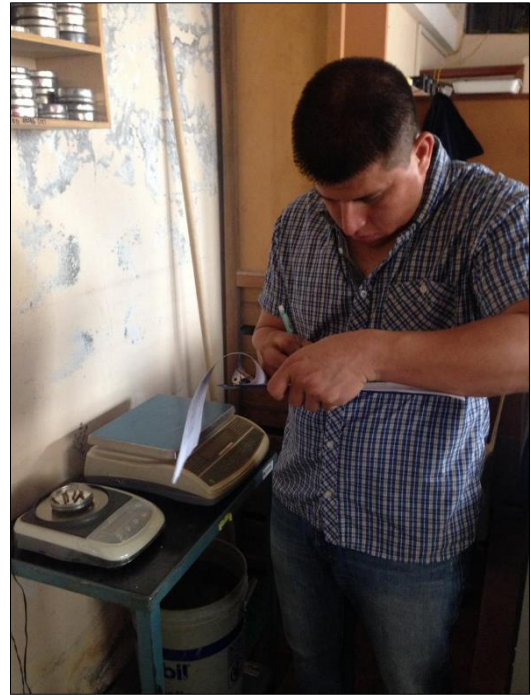
Figura 2-B. toma de pesos en seco, ensayo de límite de plasticidad.
