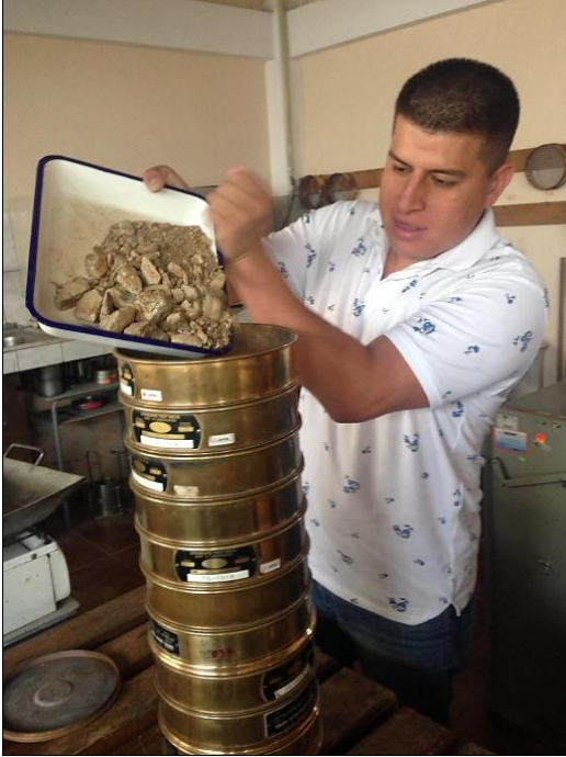
Figura 1-B. Tamizado manual de muestra seca, ensayo de granulometría.
