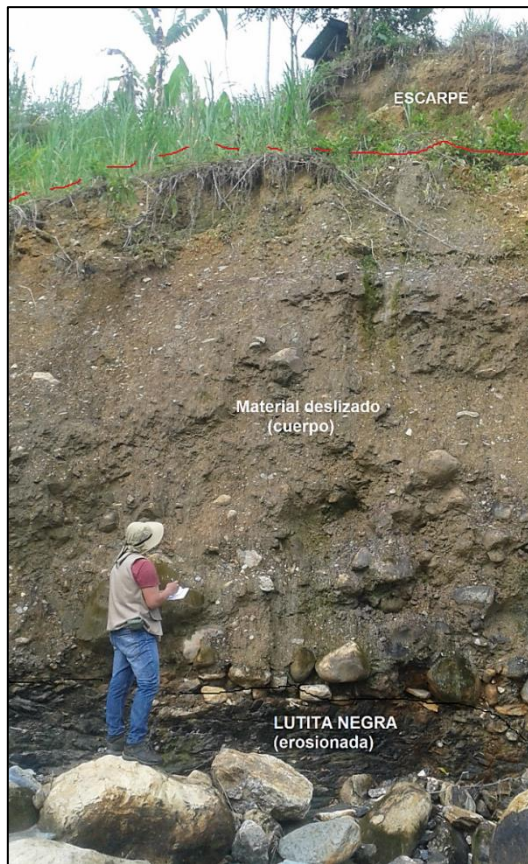
Figura 13-2. Deslizamiento rotacional de un coluvio-aluvial sobre Lutita.
