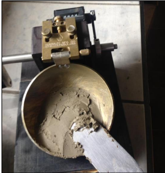
Figura 41-2. Preparación de superficie de la pasta en la Cuchara de Casagrande.
