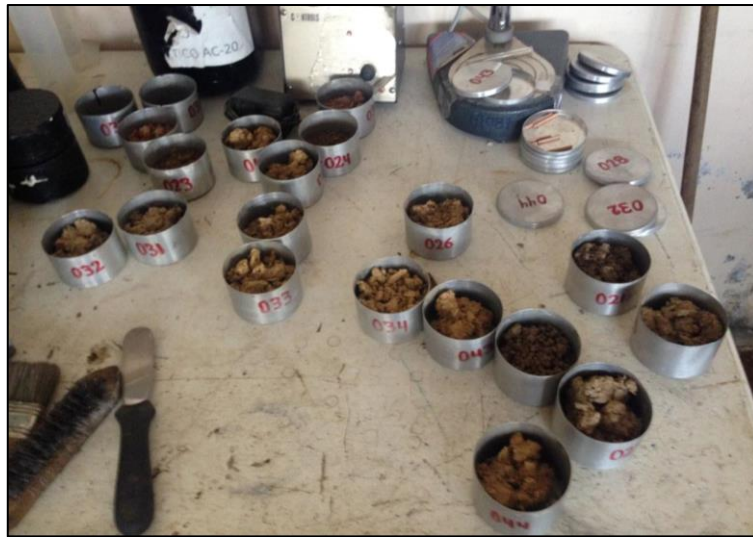
Figura 38-2. Muestras secadas al horno previo cálculo de humedad natural.
