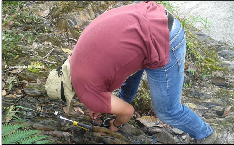
Figura 10-2. Macizo de Lutita negra con clivaje pizarroso muy fracturada.
