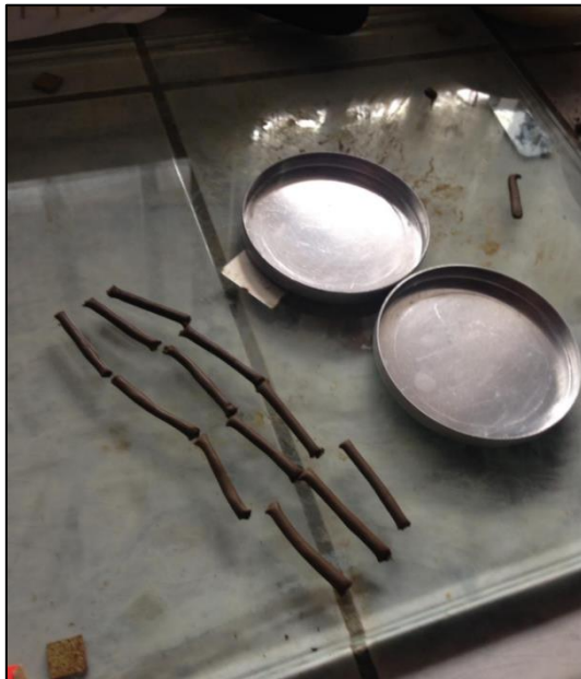
Figura 42-2. Bastoncitos del ensayo de Límite de Plasticidad.
