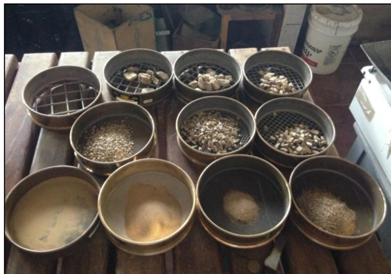
Figura 36-2. Cantidades retenidas por los tamices, acorde al tamaño de partícula.
