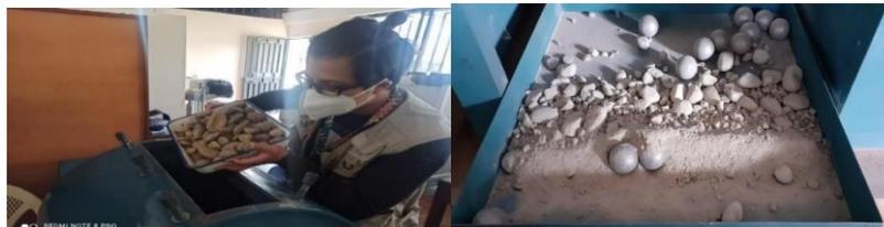
**Figura 7-3:** Colocación de muestras en medidor de abrasión
