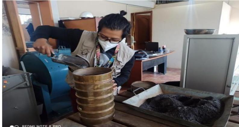
**Figura 8-3:** Colocación de muestras en tamices de granulometría
