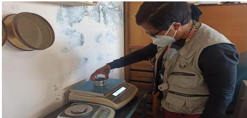
**Figura 9-3:** Pesaje del tamaño de grano por tamiz de muestra analizada
