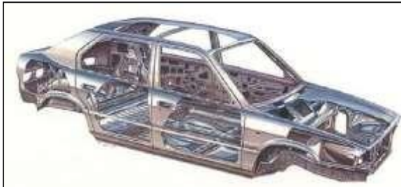
Figura 4-1: Carrocería de Unidad por Soldadura
