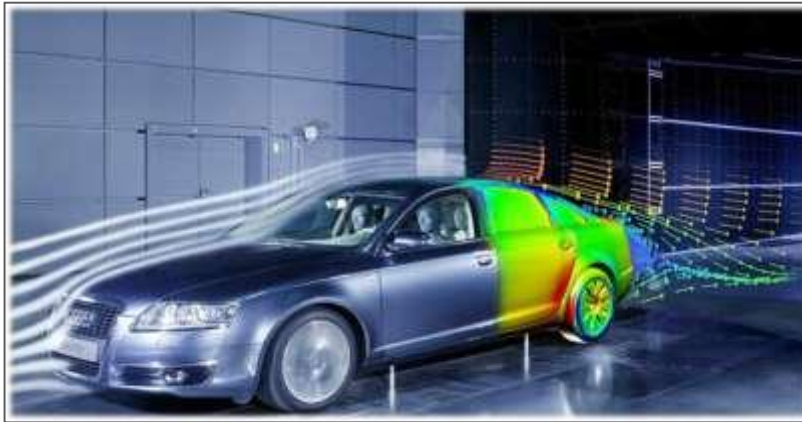
Figura 15-2: Ensayo de un vehículo Audi en el túnel de viento. Fuente: http://www.audi.es/content/dam/ngw/es/experiencia/tecnologia_y_seguridad/climatico_5.jpg .
