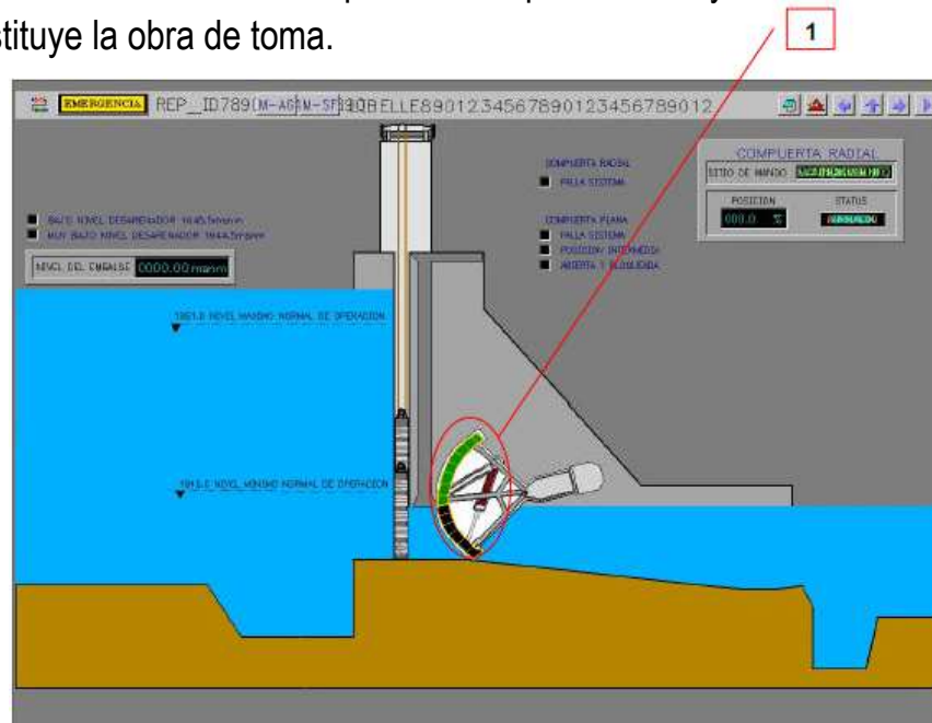
Figura III-41. Corte lateral del Desagüe de fondo del Desarenador
