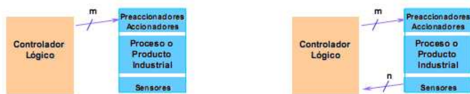
Figura II-5. Controladores en lazo abierto (izquierda) y lazo cerrado (derecha).
