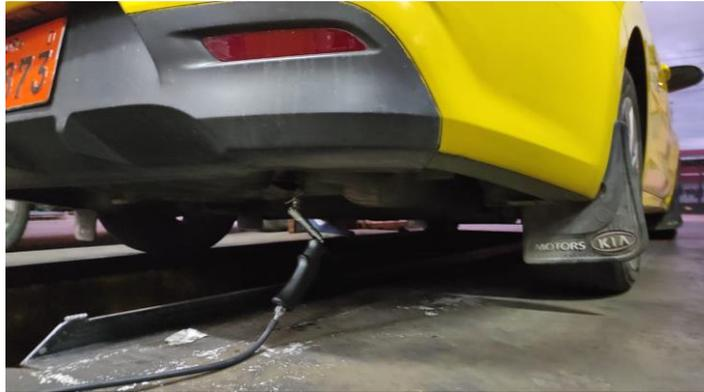
**Figura 4-2:** Conexión de la sonda lambda a l tubo de escape.
