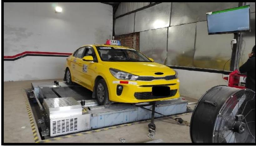
**Figura 10-2:** Sujeción del vehículo con correas de seguridad.
