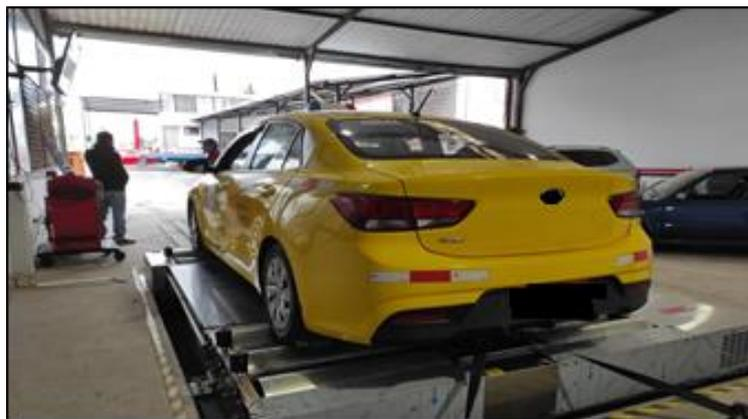
**Figura 9-2:** Puesta del vehículo en el dinamómetro.
