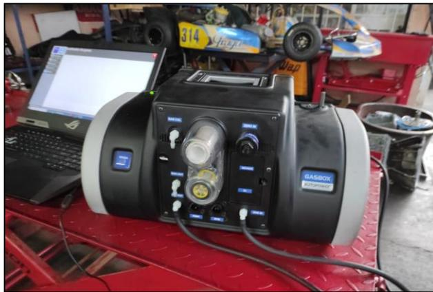
**Figura 2-2:** Analizador de gases.
