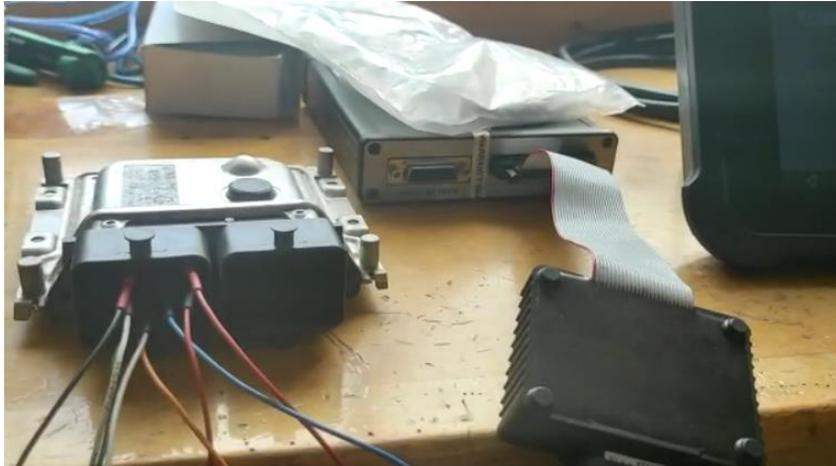
**Figura 21-2:** Conexión de los puertos de comunicación de la ECU
