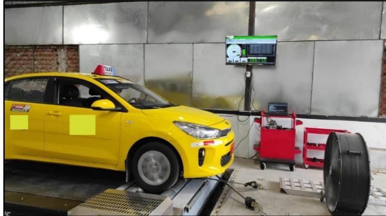
**Figura 13-2:** Prueba con el vehículo acelerado a fondo.
