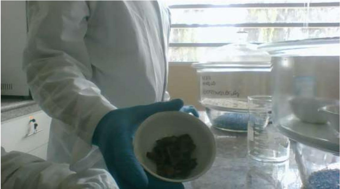
**ANEXO D: PESAJE DE LAS MUESTRAS SECAS PARA DETERMINACIÓN DE HUMEDAD**
