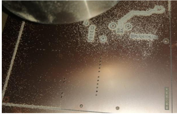
Figura 17-3: Proceso de perforación en CNC. Fuente: Sarango Santiago, Vallejo Andrés. 2020
