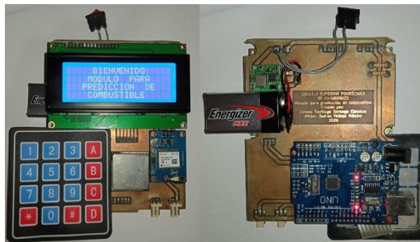
Figura 18-3: Instalación de componentes. Fuente: Sarango Santiago, Vallejo Andrés. 2020
