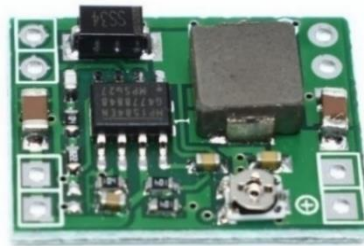
Figura 8-3: Convertidor de voltaje DC-DC.
