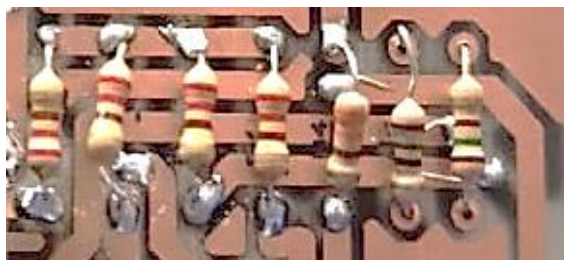
Figura 8-3: Soldadura de resistencias Realizado por: Alex Paguay, Alexander Ramos. 2021
