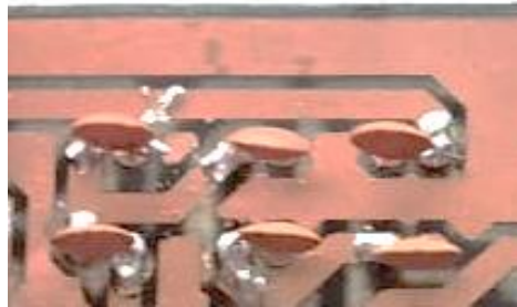
Figura 10-3: Soldadura de condensadores Realizado por: Alex Paguay, Alexander Ramos. 2021
