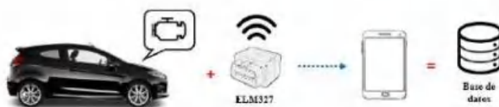
Figura 24-2. Funcionamiento del puerto de diagnóstico a bordo (OBD). Realizado por: (León Jiménez, 2019: pp. 61-68).
