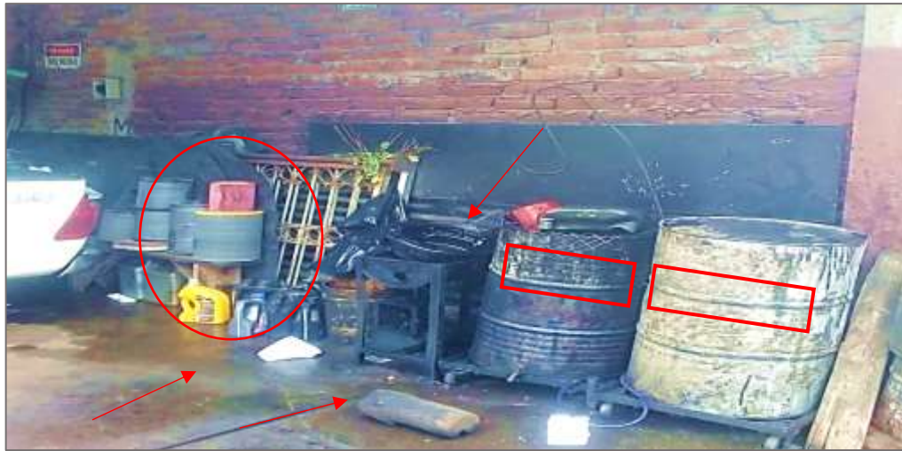
Figura 7-3: Falta de señalización en recipientes de almacenamiento de aceite residual
