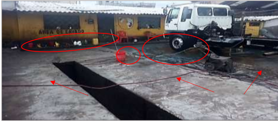
Figura 8-3: Limpieza de aceite lubricante del piso mediante agua con detergente
