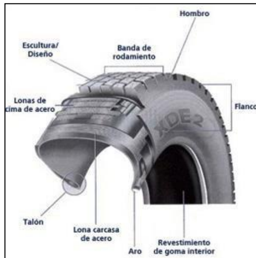
Figura 12-1: Partes de un neumático
