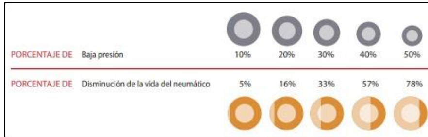
Figura 21-1: Disminución de la vida útil del neumático en presión
