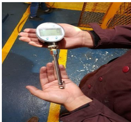
Figura 2-2: Medidor de presión
