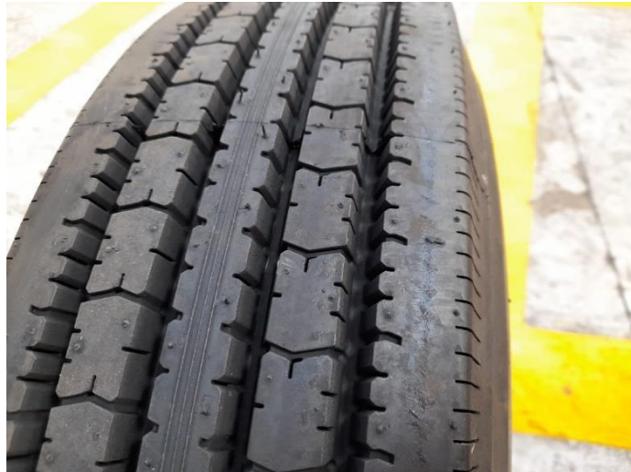
Figura 5-3 Inspección visual del neumático
