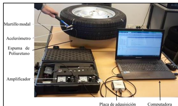
Figura 7-1: Disposición de elementos para el ensayo
