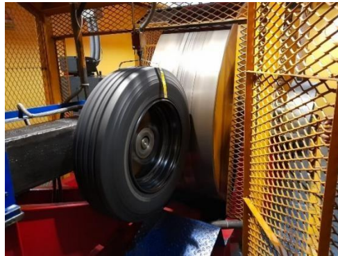
Figura 12-2: Inicio del ensayo de aguante
