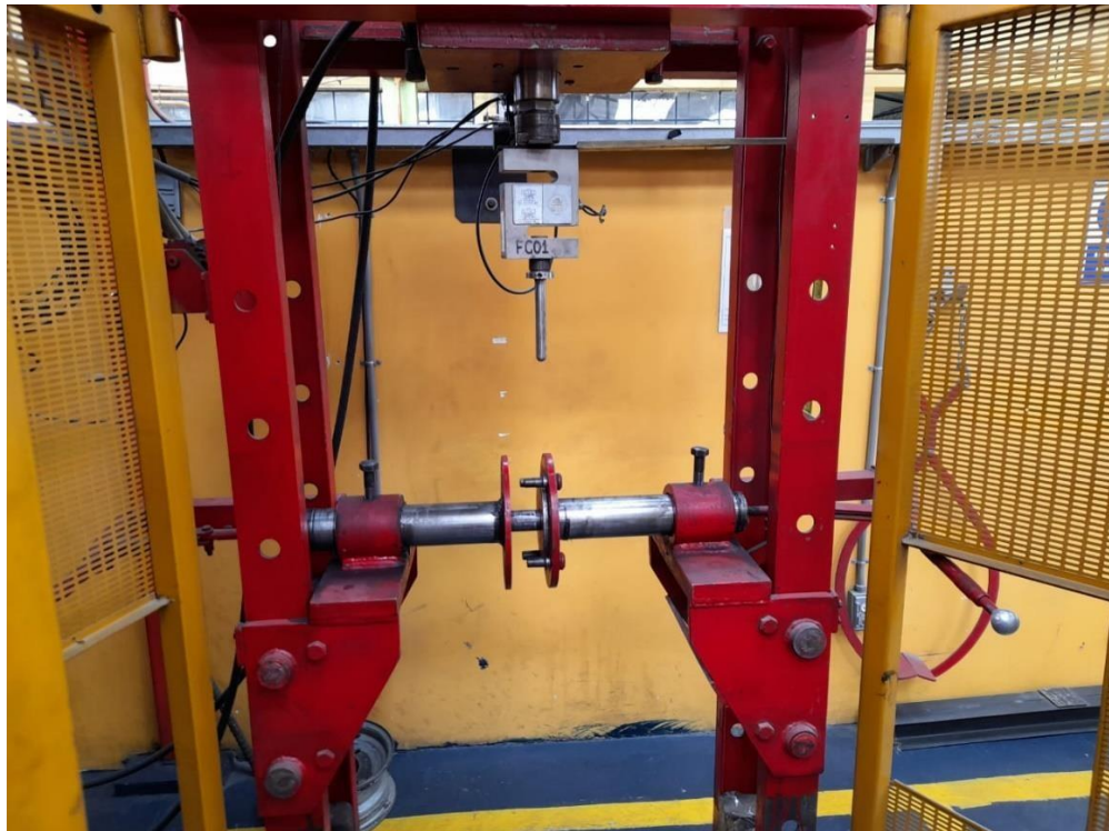
ANEXO F: Máquina para el desarrollo del ensayo de penetración
