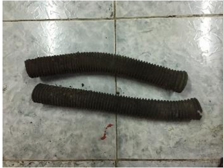
Figura 16-3. Tubos del sistema neumático
