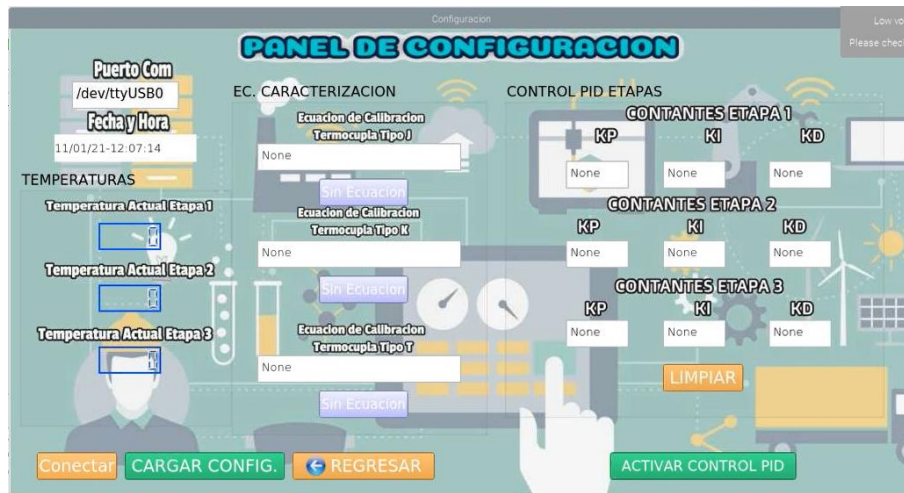
Figura 9-4. Requerimientos iniciales para la calibración de termopares. Realizado por: Guerrero, G., Arias, P., 2021.
