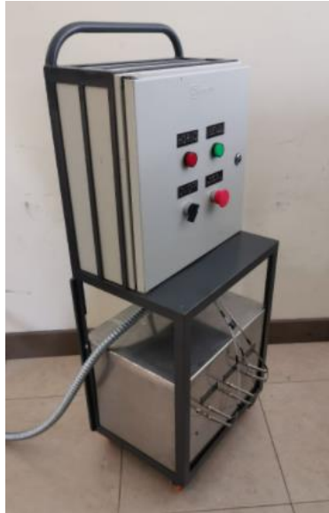
Fig 1. Banco de Calibración de termocuplas y control del horno
