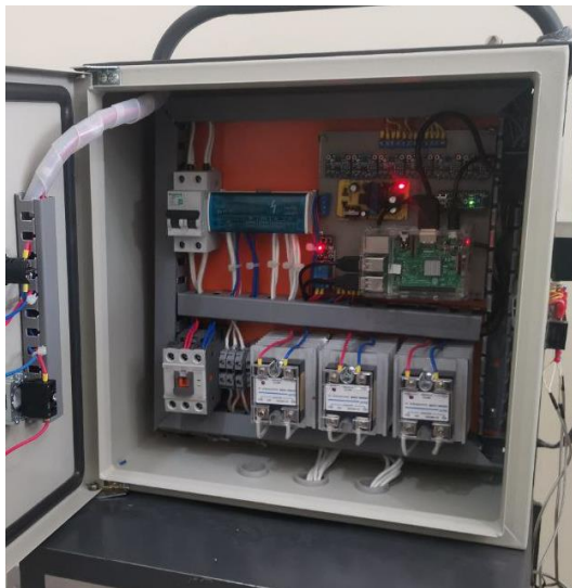
Figura 38-3. Distribución de los dispositivos en el tablero de control. Realizado por: Guerrero, G., Arias, P., 2020.
