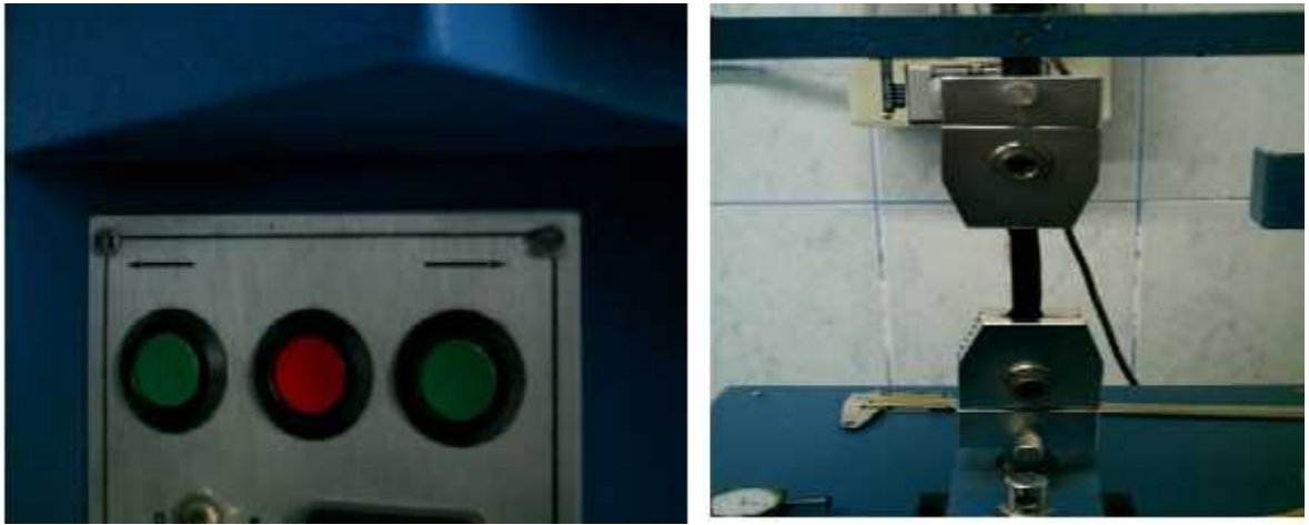
Fotografía 7-2 . Puesta en marcha del prototipo mecánico para medir la resistencia a la tensión del cuero.
