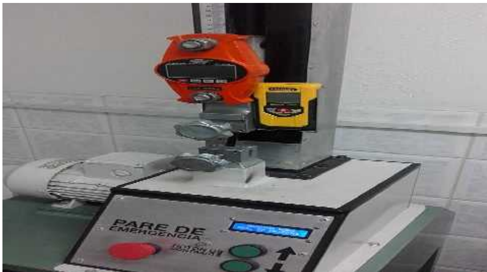
Fotografía 2-2. Partes de un equipo para realizar la medición de la resistencia a la tensión el cuero.
