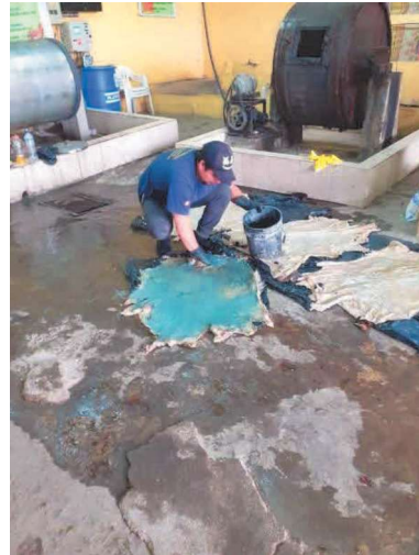
Anexo M. Evidencia fotográfica del proceso de pelambre por embadurnado.
