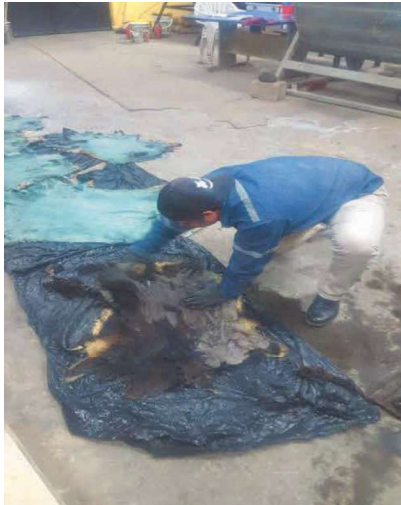
Anexo M. Evidencia fotográfica del proceso de pelambre por embadurnado.
