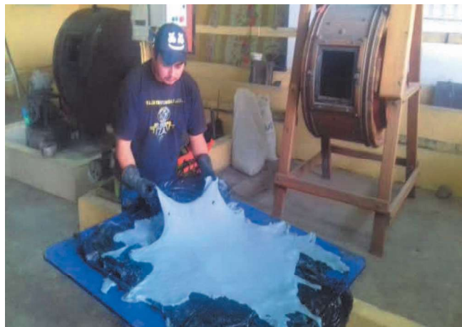
Anexo O. Evidencia fotográfica del proceso del curtido y perchado.
