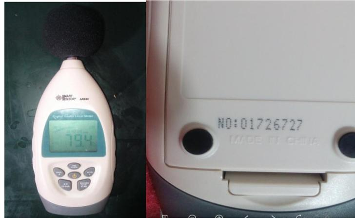
**Figura 4-3:** Medidor de ruido SMART SENSOR
