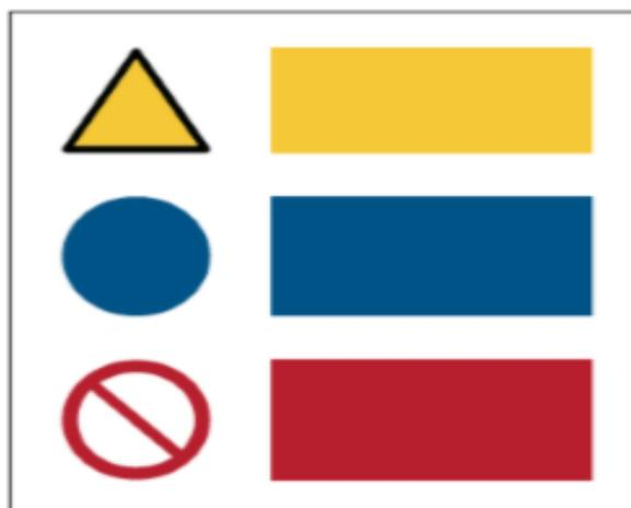
**Figura 11-2:** Exigencia de diseño de una señal combinada verticalmente
