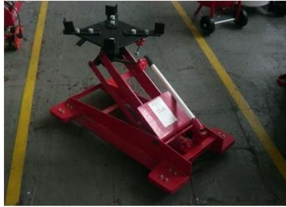
**Figura 14-4:** Gato hidráulico para caja de cambios
