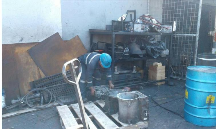
**Figura 13-3:** Mecánico colocando el cárter de la transmisión en un lugar no apropiado.
