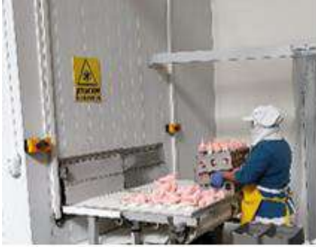
Figura 12-3. Túnel de frío para congelar los helados. Realizado por: (Autor, 2020)
