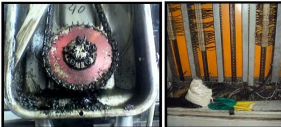
**Figura 16 – 3:** Exceso de grasa en piñón y objetos extraños en panel eléctrico
