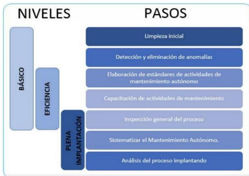
**Figura 7-2:** Niveles y pasos del Mantenimiento Autónomo
