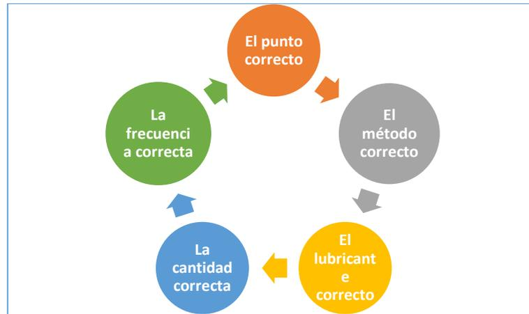
**Figura 30-3:** Las 5 C de lubricación
