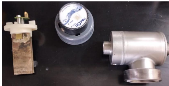
Figura 6-2 Componentes interiores de la celda electroquímica del equipo T-NEC
