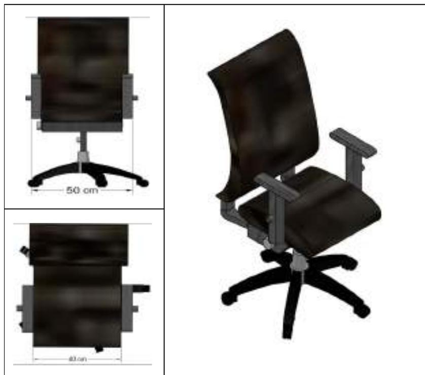
**Figura 4.4.** Dimensiones técnicas requeridas para silla de trabajo
