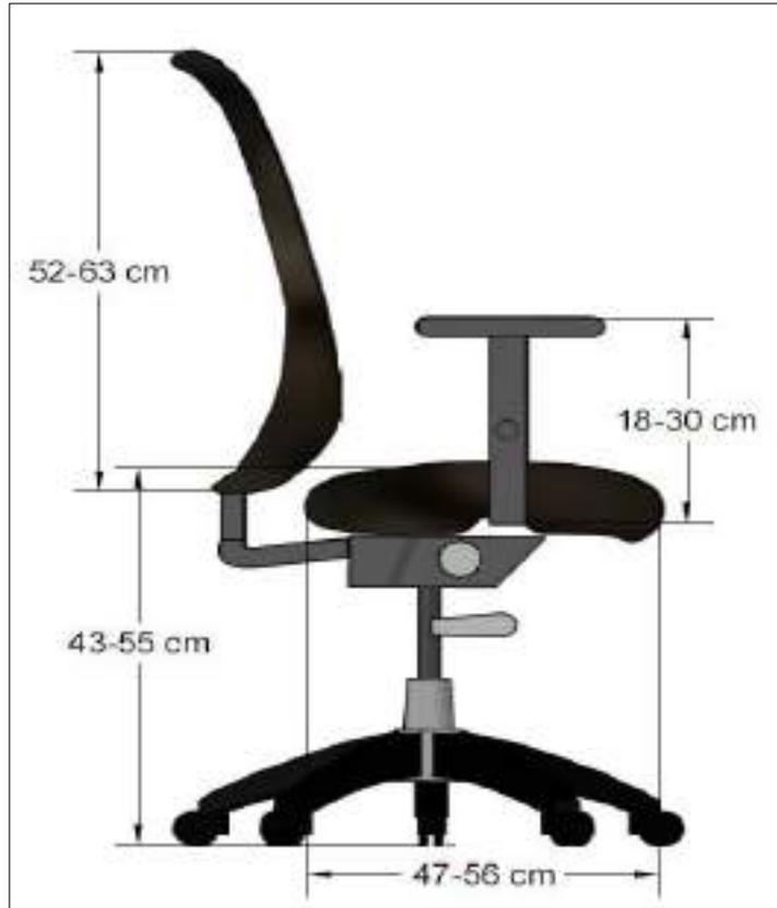
**Figura 3.4.** Vista lateral, dimensiones técnicas de la silla de trabajo
