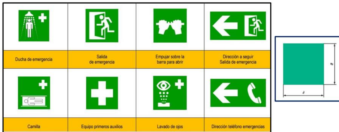
Figura 22-2: Señalética de evacuación, ejemplos
