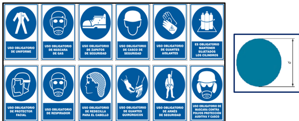
Figura 20-2: Señalética obligatoria, ejemplos y parámetros de construcción
