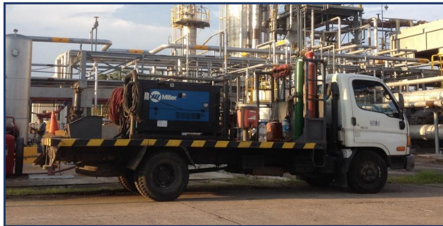
Figura 4-3: Equipo completo de soldadura
