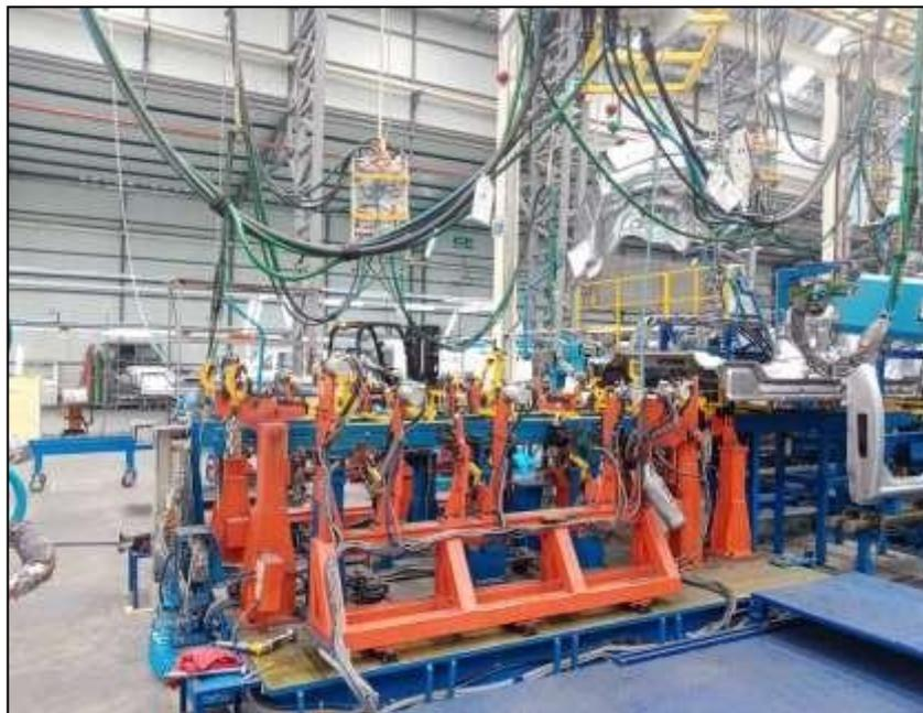
**Figura 4-3:** Estación de trabajo para soldadura depunto.
