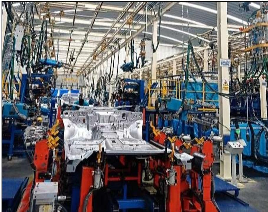
**Figura 2-3:** Línea de soldadura de punto de la planta.
