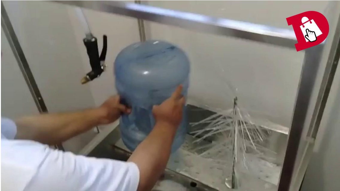
Figura 36-2: Sistema de lavado
