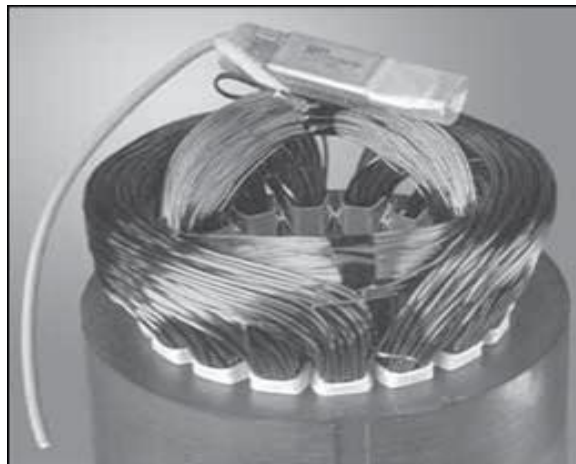
Figura 5-2: Protección sobrecarga Fuente: (Franklin 2008).
