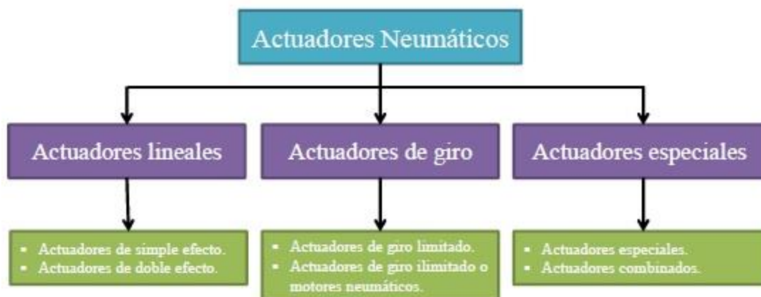
Figura 22-2: Clasificación para los actuadores neumáticos Fuente: (Fpeingenieriaelectrica 2016)
