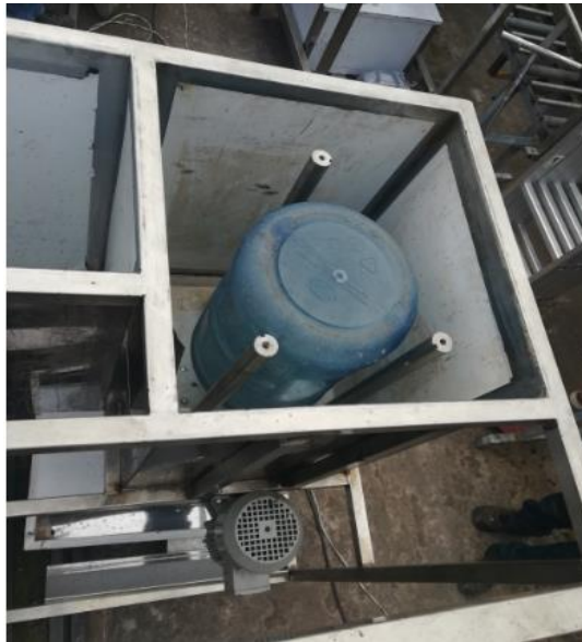
Figura 43-3: Estación de lavado con motores. Realizado por: Iván Silva, 2021
