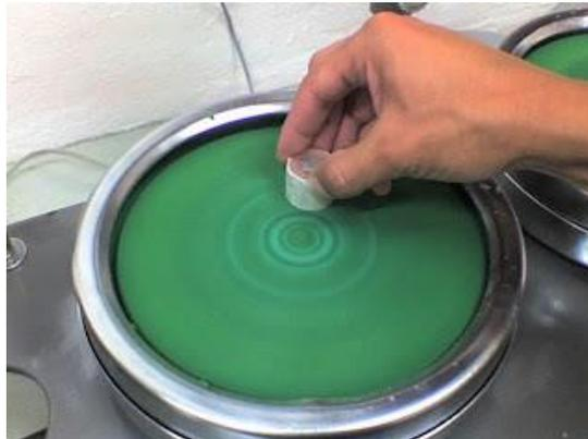
**Figura 5-3:** Pulido de la probeta
