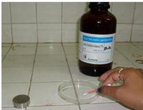
**Figura 8-3:** Ataque químico metalográfico
