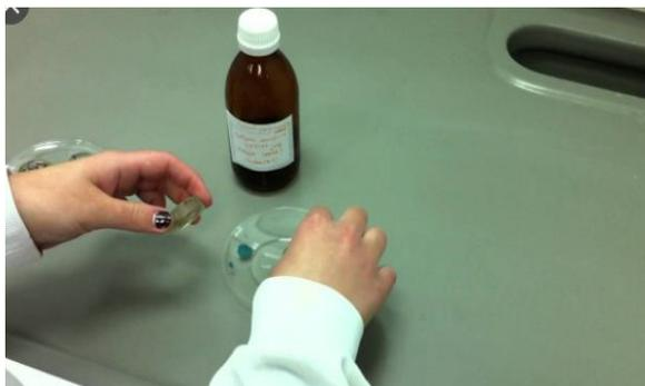
**Figura 7-2:** Ataque químico a las probetas
