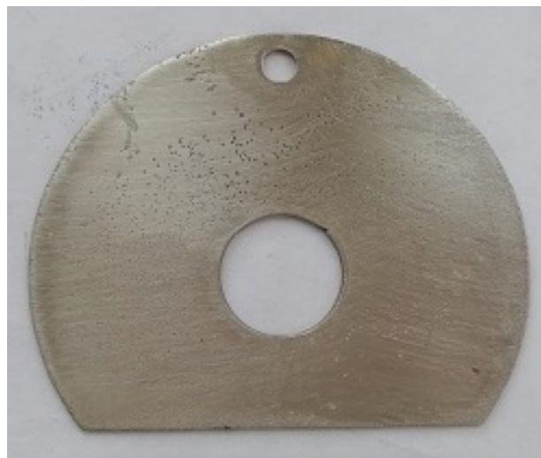
Figura 10. Estado final del cátodo en el reactor de celda húmeda.
