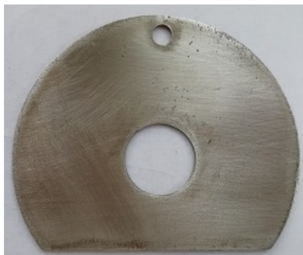
Figura 9. Estado final del ánodo en el reactor de celda húmeda.
