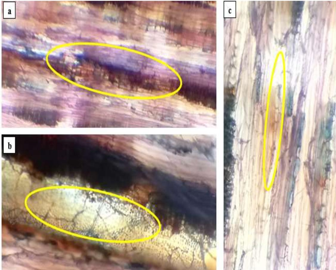
**Figura 36.** Sección radial *Vochysia brachylineae* (Tamburo) a. Radios heterocelulares con una ruta de células marginales. b. Vaso con punteaduras radiovasculares. c. Fibras septadas alargadas.
