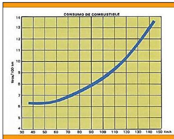
Figura 16-2: Curva del consumo de combustible en función a la velocidad
