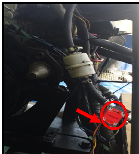
Figura 45-3: Ubicación del sensor de flujo
