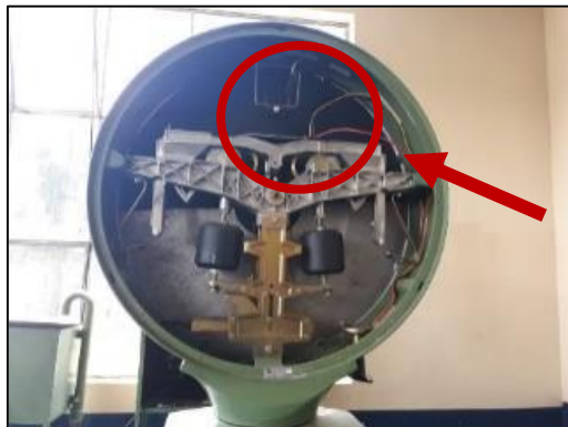
Figura 47-3: Ubicación del sensor infrarrojo
