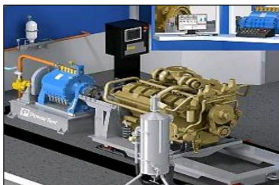
Figura 3-2. Banco dinamométrico conectado directamente al eje del motor
