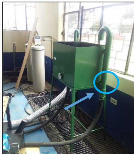
Figura 43-3: Ubicación del sensor LM35
