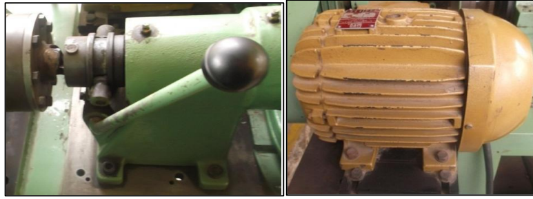
Figura 15–3: Palanca de accionamiento y motor trifásico
