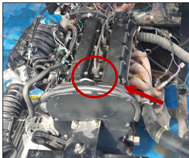
Figura 49-3: Ubicación del sensor CMP
