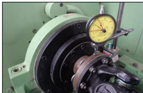
Figura 12-3. Comprobación del rotor
