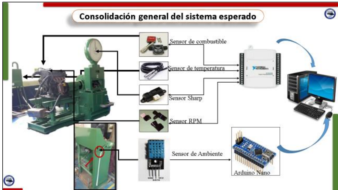
Figura 25–3: Consolidación del sistema del sistema de instrumentación virtual
