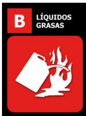
Figura 24-3: Incendio clase B.
