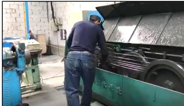
**Figura 3-2:** Proceso de trefilado.
