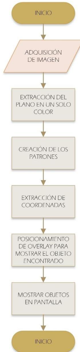
**Figura 39-3:** Diagrama de flujo para procesamiento de imágenes para detección de objetos
